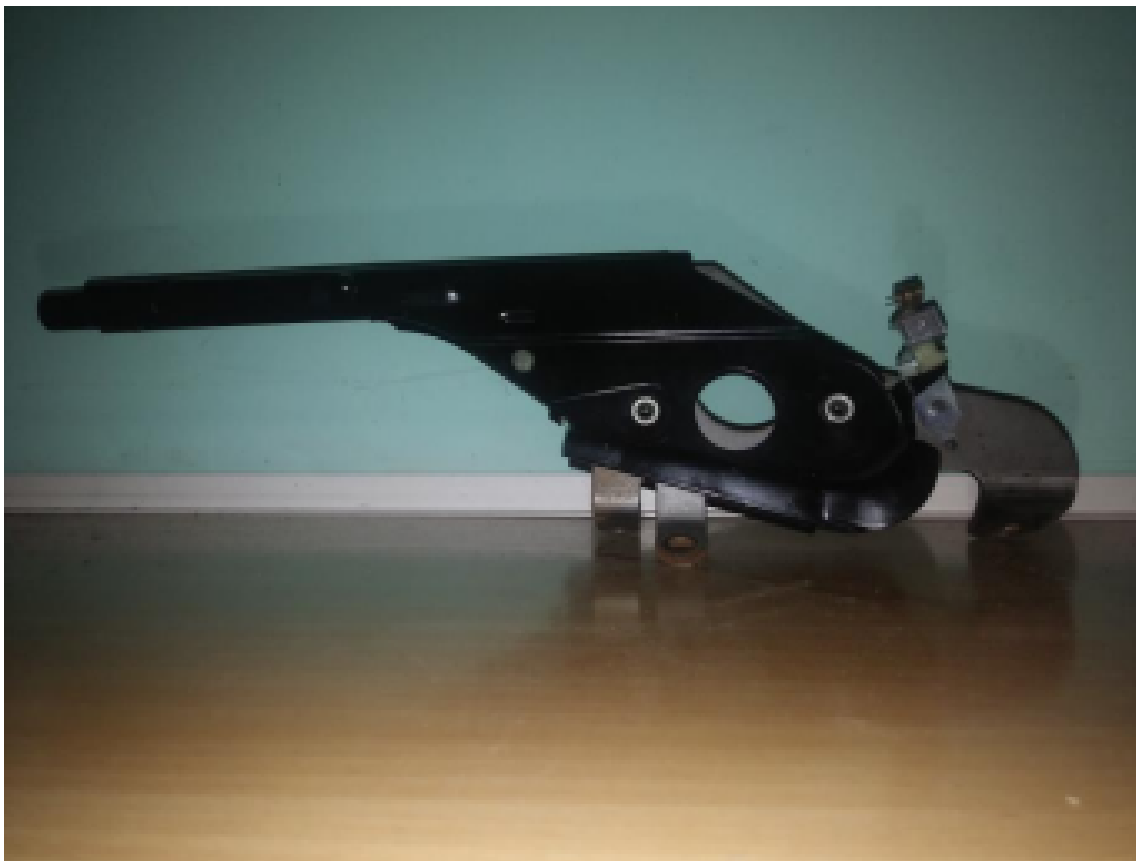
Slika 12. Prikaz ručne poluge u opuštenu stanju
