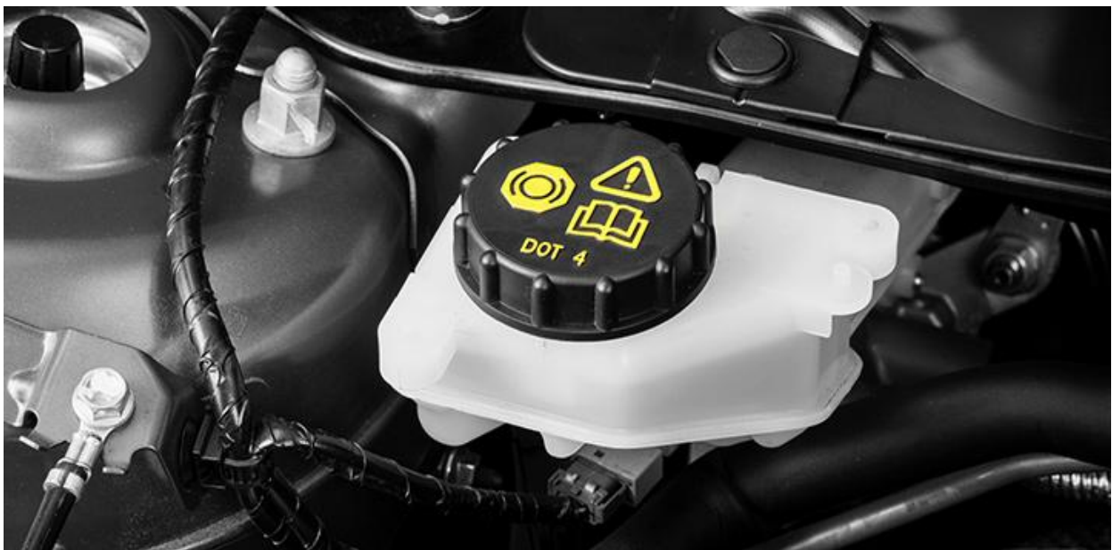
Slika 14. Spremnik tekućine za kočenje sa označenim DOT-om
