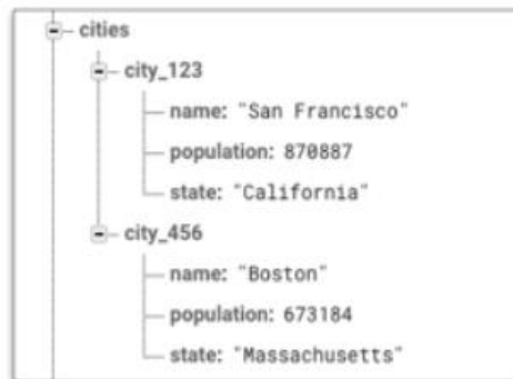
Slika 14. Primjer Firebase Realtime baze podataka
