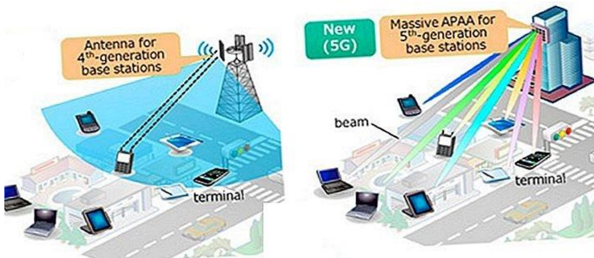
Slika 4.1.1 Razlika između 4G antena i MIMO antena, tj. antena koje koriste 5G sustavi
