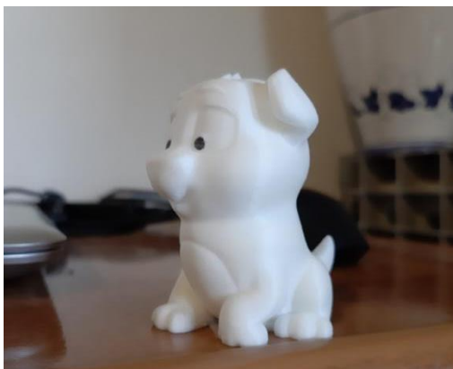
Slika 5 - Model dobiven kućnom izradom koristeći FDM metodu
