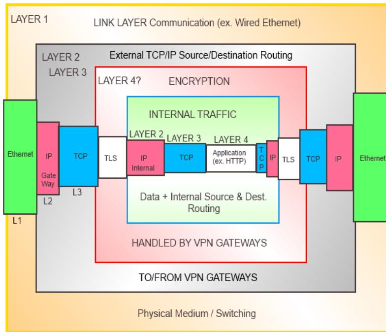
Slika 9. – TCP/IP diagram
