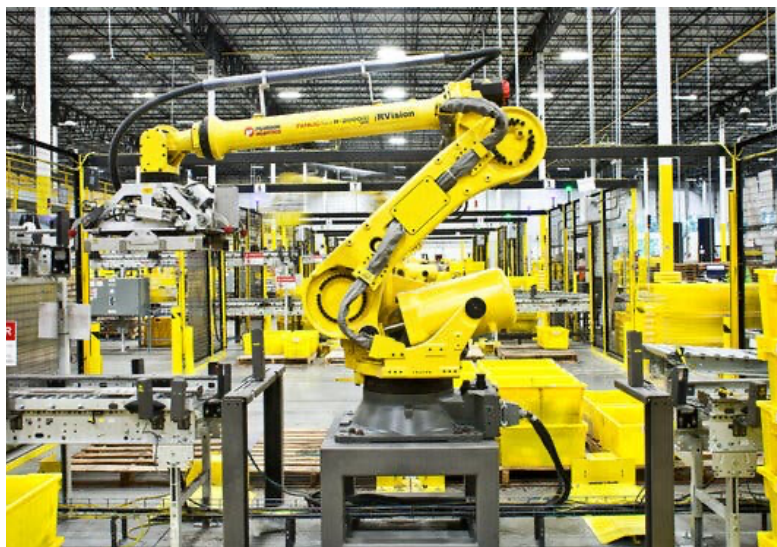
Slika 22. Robotska ruka za automatizirani prijenos paketa na paletu ili policu
