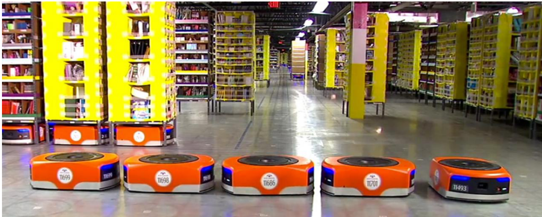
Slika 21. Roboti unutar Amazonovog skladišta za automatizirano prenošenje cjelokupnih polica sa proizvodima
