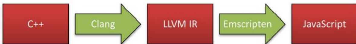
Slika 13: Tijek rada Emscripten prevodioca (McAnlis et al. , 2014)
