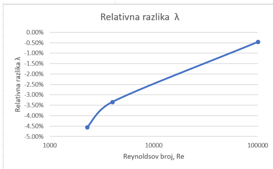
Slika 39. Relativna razlika dobivenih \lambda s povećanjem Re broja
