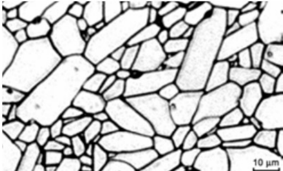
Slika 15. Prikaz strukture Al 2 O 3 [9]
