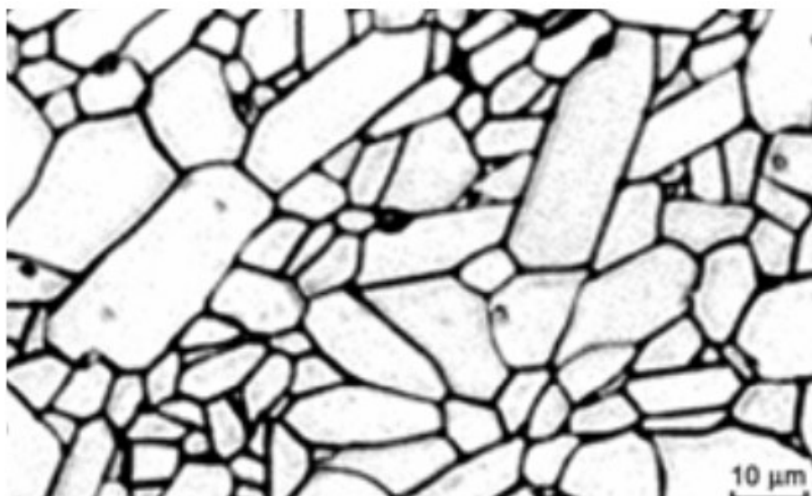
Slika 15. Prikaz strukture Al 2 O 3 [9]
