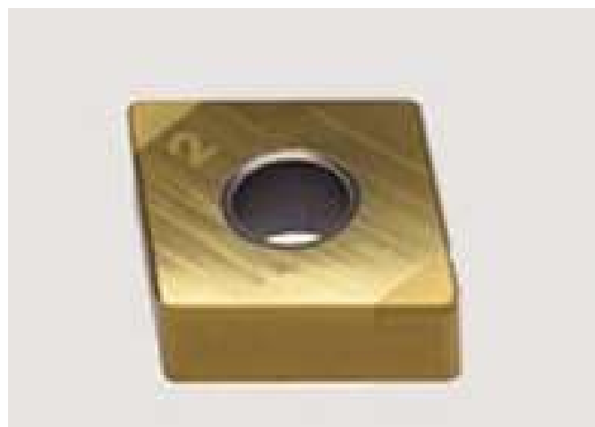
Slika 28. Izmjenjiva pločica CBN-a. [5]
