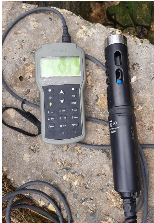
Slika 5. Sonda za određivanje hidrografskih parametara (Izvor: vlastita fotografija, 2022)
