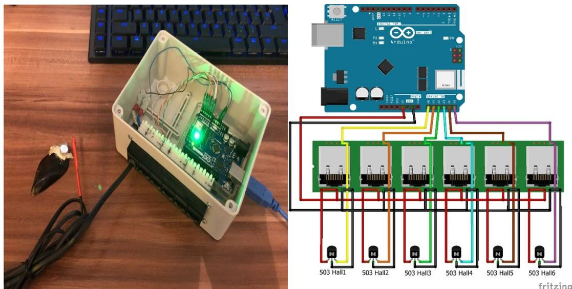
**Slika 10.** Centralno kućište i shema spajanja Hall senzora na mikrokontroler.
