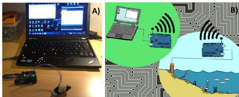
**Slika 7.** Moj prvi demonstracijski sustav za mjerenje otvorenosti ljuštura dagnje *M. galloprovincialis*: A) računalo, mikrokontroler, dagnja s Hall senzorom razvijen za početne demonstracijske potrebe mjerenja; B) hipotetski planirani mikrokontrolerski sustav za online praćenje ponašanja dagnji za potrebe terenskih istraživanja.
