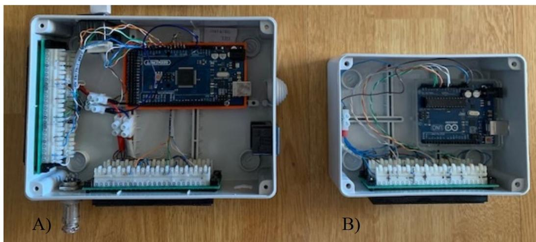
**Slika 5.** Izvedeni laboratorijski mikrokontrolerski sustavi (VG-MM) za praćenje VG ponašanja, filtriranja za: A) 12 dagnji (6+6 kanala, UTP panel, Arduino Mega 2560 R3) uz mogućnost praćenja uvjeta u prostoru tijekom pokusa te temperature morske vode; B) 6 dagnji (6 kanala, UTP panel, Arduino Uno WIFI R2) koji ima mogućnost wifi povezivanja i prebacivanja podataka na lokalnu mrežu.
