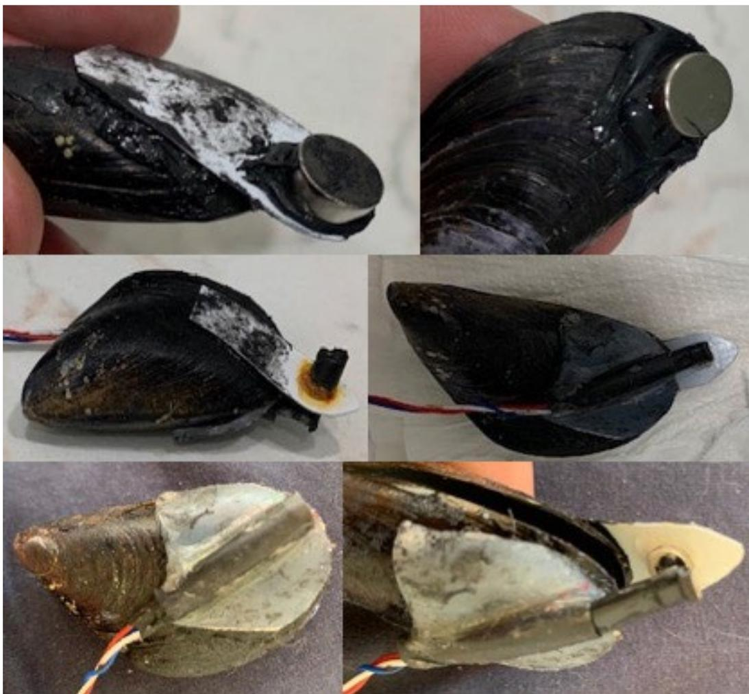
*Slika 9. Različiti načini pričvršćivanja senzora i magneta na ljušturu dagnji.*
