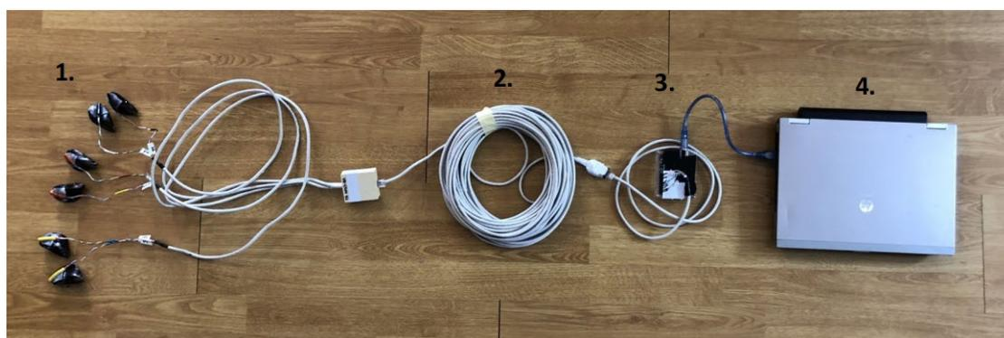
**Slika 4.** Radni prototip mikrokontrolerskog sustava VG-MM za praćenje funkcije filtriranja (VG) dagnji: 1. dagnje s spojenim Hall sensorima (6); 2. Produžni UTP kabel; 3. Mikrokontroler Arduino; 4. Prijenosno računalo.
