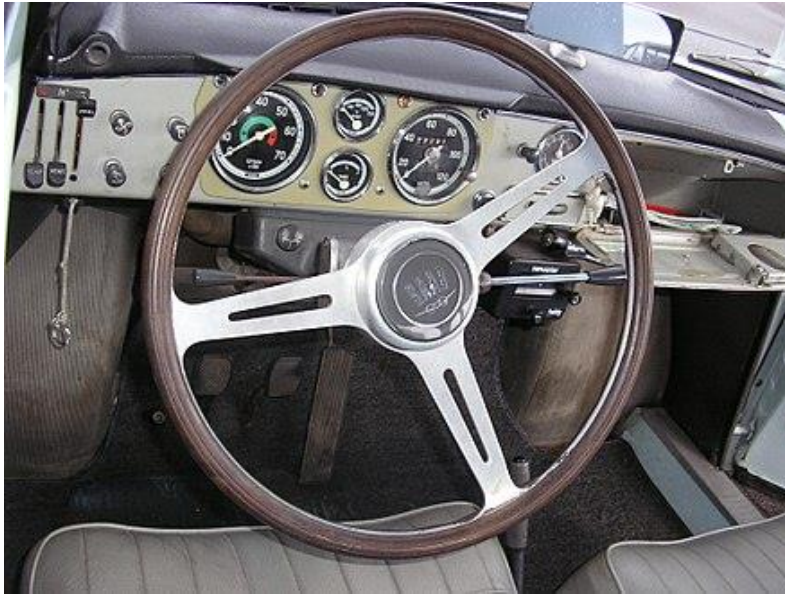
Slika 5 - Halda Tripmaster je postavljen ispod instrumenta Saaba GT8500 (izvor: http://car-from-uk.com/saab_gt750/ )
