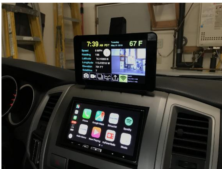
Slika 13 - Carputer kodiran u Pythonu-u baziran na Raspberry Pi, ugrađeno u Toyota (izvor: https://github.com/jbuehl/carputer )
