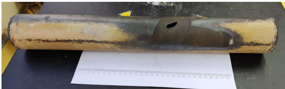
Slika 14: Cijev s pukotinom iz TE Plomin
