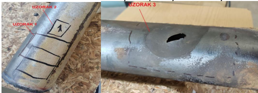
Slika 15: Plan uzorkovanja za ispitivanje u laboratoriju
