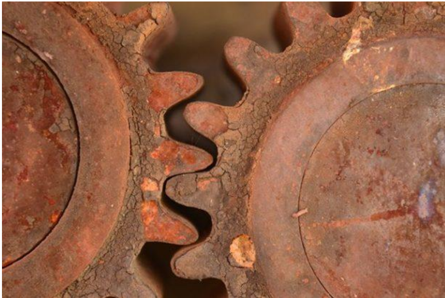
Slika 2: Opća koruzija na zupčanicima [16]
