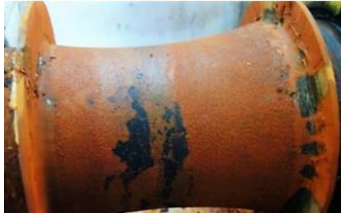
Slika 9: Korozijski zamor na dijelu osovine [11]
