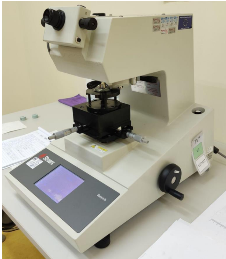
Slika 40: Tvrdomjer STRUERS DURAMIN 2
