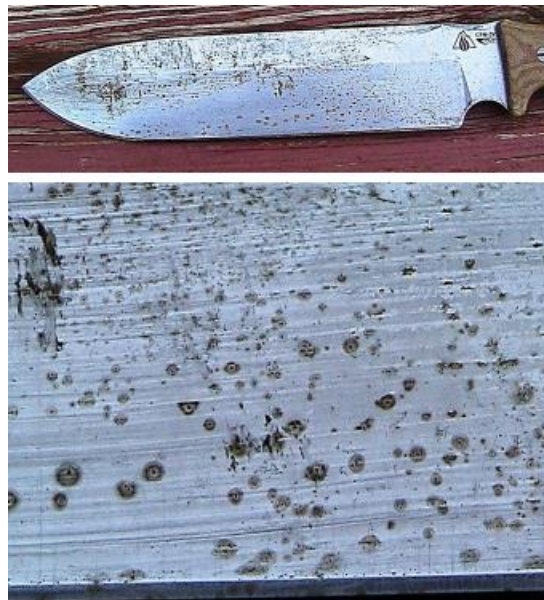
Slika 4: Pjegasta korozija oštrice noža [19]
