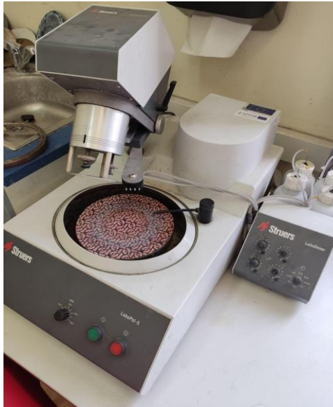
Slika 18: Uređaj za brušenje i poliranje STRUERS LABOPOL
