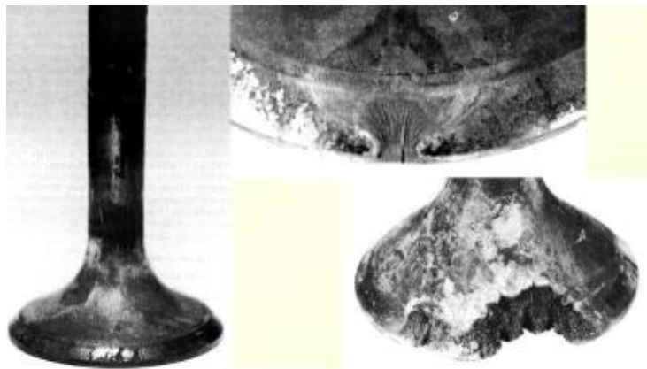
Slika 1: Oštećenje ventila uzrokovano kemijskom korozijom [11]
