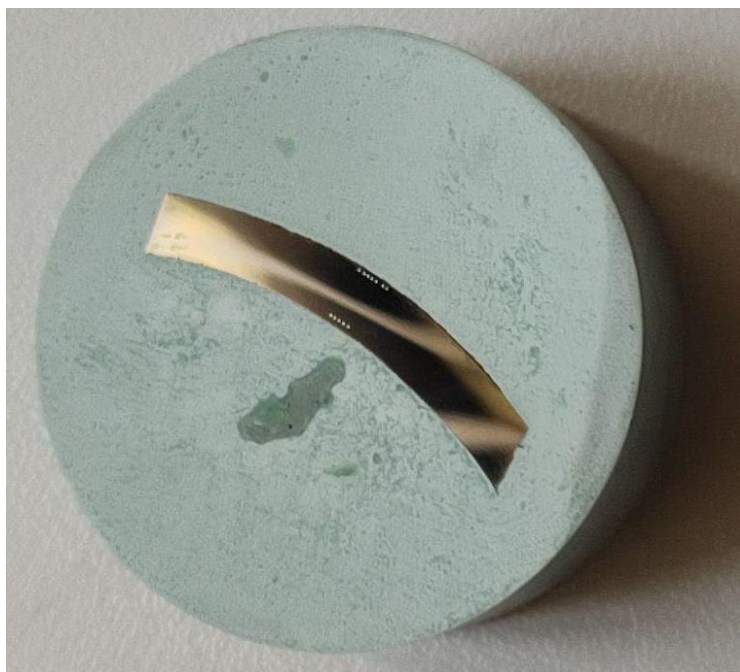
Slika 41: Uzorak nakon mjerenja tvrdoće
