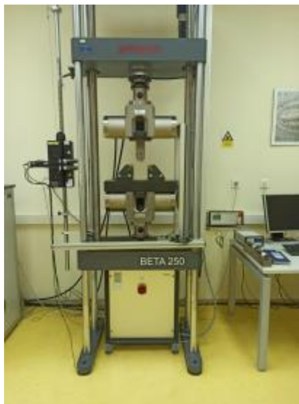
Slika 17: Univerzalna statička kidalica MESSPHYSIK BETA 250
