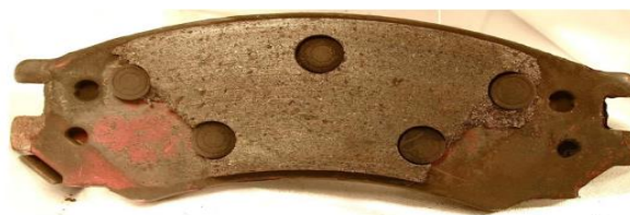
Slika 8: Tarna korozija automobilske kočnice [27]
