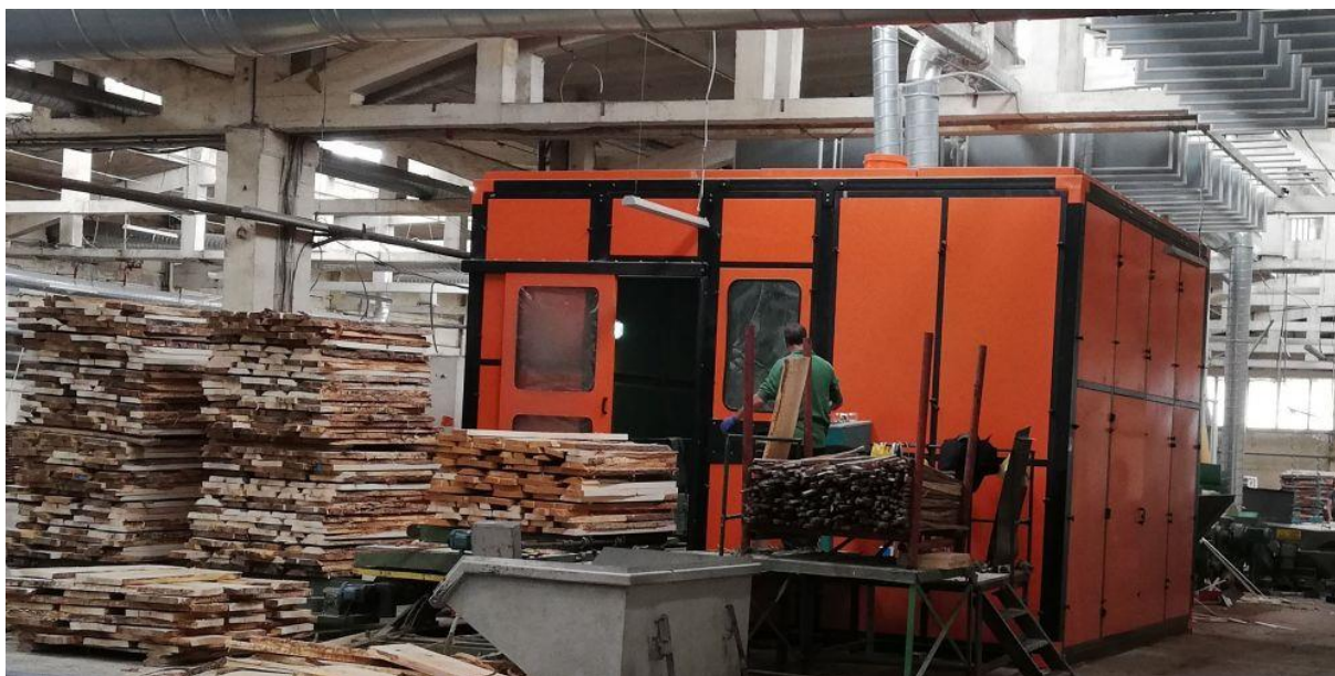
Slika 12. Vanjski izgled zvučno izolirane prostorije
