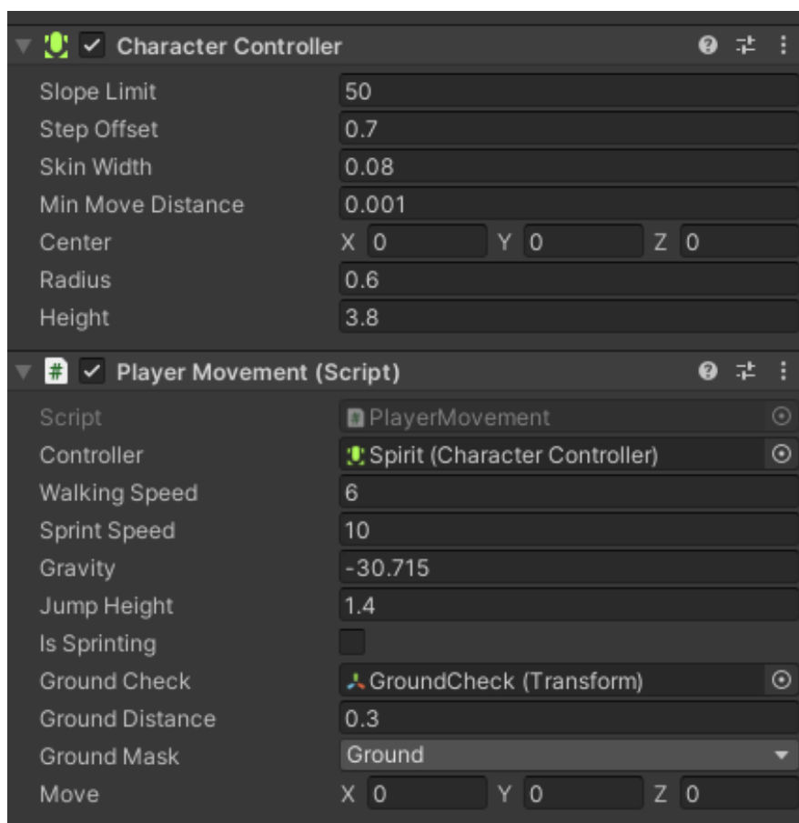
Slika 5 Javne varijable od CharacterController i PlayerMovement skripti
