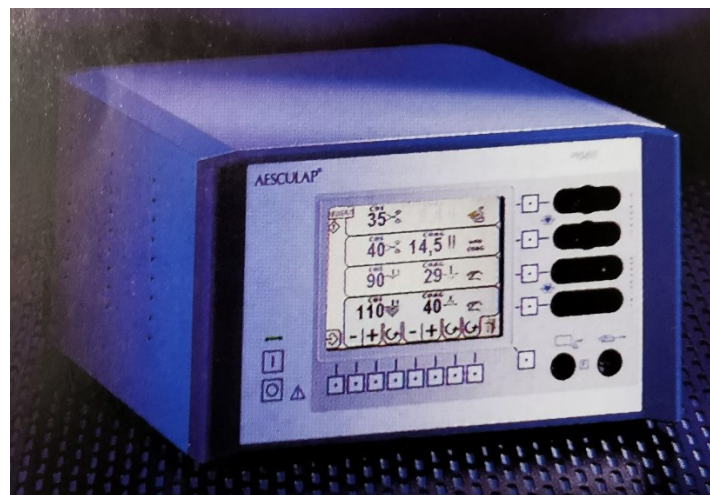
Slika 8. Elektrojedinica za primjenu u endoskopskoj kirurgiji (Čala i sur., 2001)
