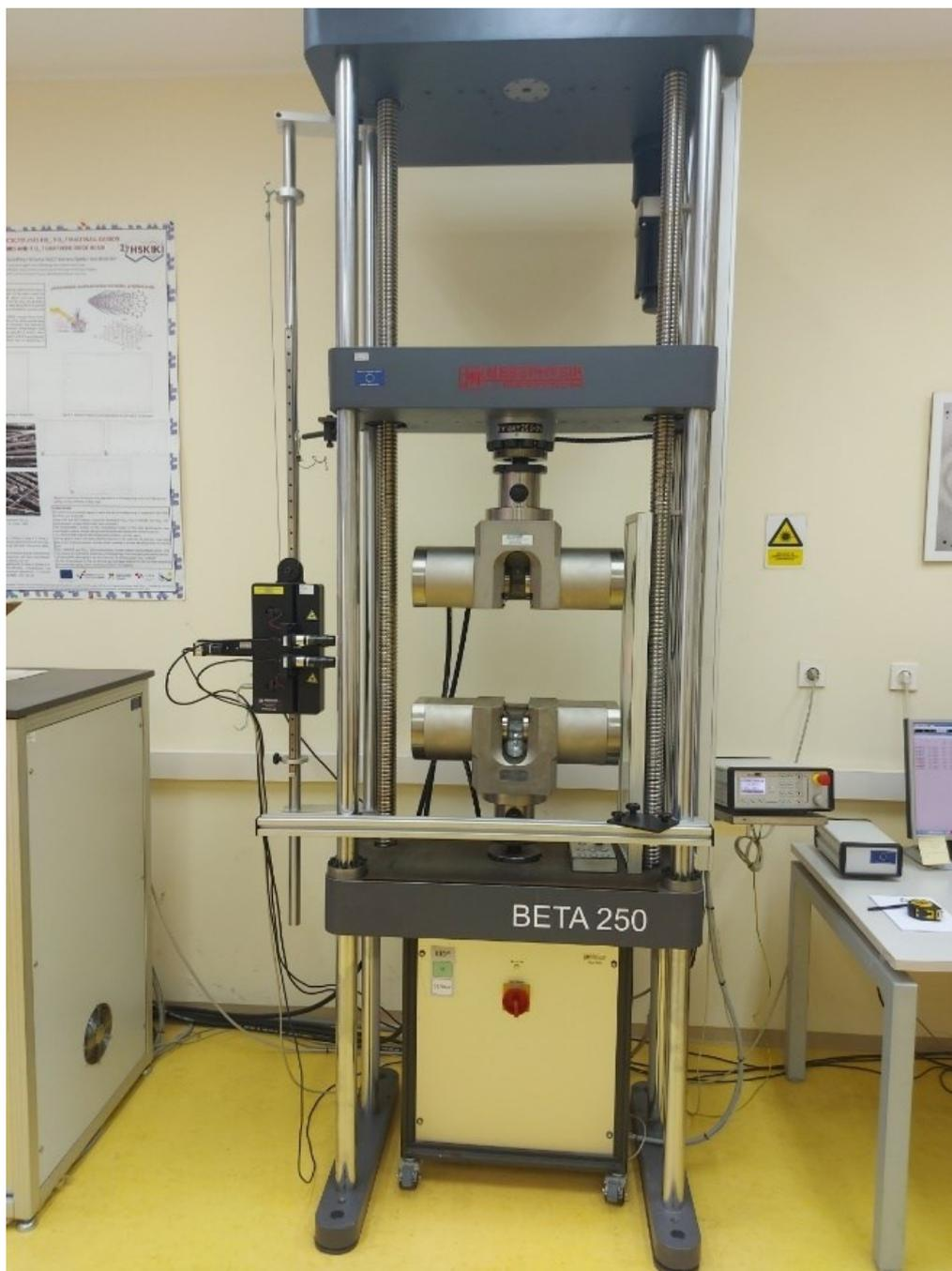
Slika 17. Hidraulička kidalica MESSPHYSIK BETA 250
