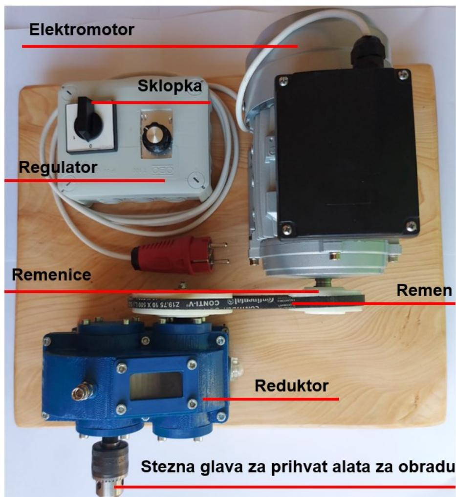
Slika 60. Dijelovi višenamjenskog stroja za obradu odvajanjem čestica
