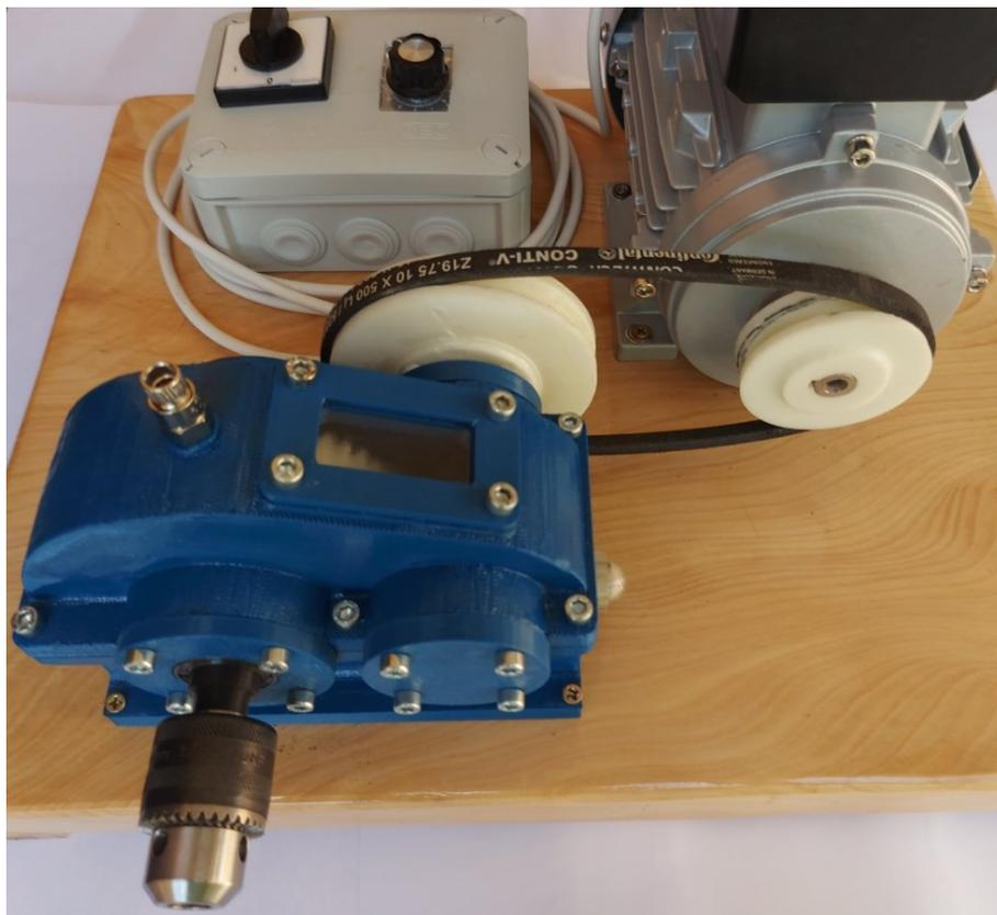
Slika 62. Stroj za obradu odvajanjem čestica nakon montaže
