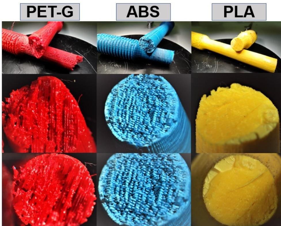
Slika 25. Poprečni presjeci epruveta nakon ispitivanja čvrstoće
