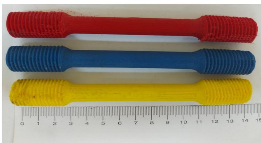
Slika 14. Ispitne epruvete za vlačno ispitivanje čvrstoće
