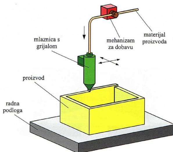
Slika 5. Načela postupka taložnog srašćivanja (FDM) [6]
