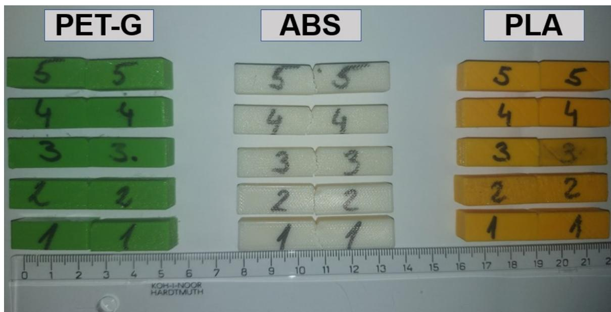
Slika 38. Ispitne epruvete nakon ispitivanja udarne radnje loma
