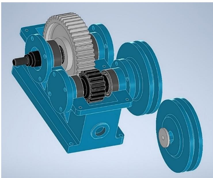
Slika 46. Reduktor nakon modeliranja s otvorenim gornjim kućištem
