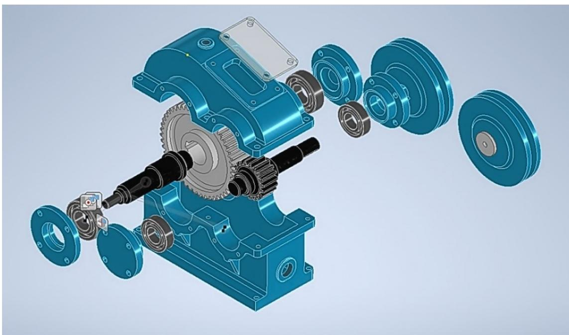
Slika 47. Svi dijelovi reduktora prikazani u 3D obliku
