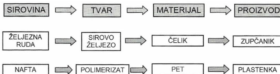
Slika 4. Primjeri proizvodnje čeličnih i polimernih proizvoda [7]
