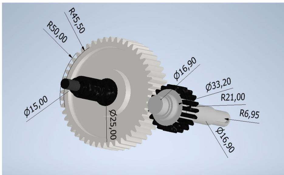
Slika 44. Modeliranje zupčanika i osovine reduktora
