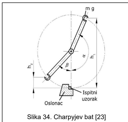
Na slici 34 prikazana je geometrija Charpyjevog bata koji se u ovome radu koristio za ispitivanje udarne radnje loma. Ispitivanje epruveta izvodilo se pomoću Charpyevog bata za ispitivanje na udar Zwick/Roell RKP 450 prema normi EN ISO 148 - 1:2010. Ispitna epruveta je dimenzije 55 x 10 x 10 mm (duljina x širina x visina) s V zarezom.
