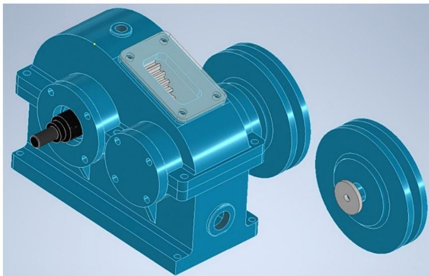
Slika 48. Reduktor u 3D obliku nakon modeliranja
