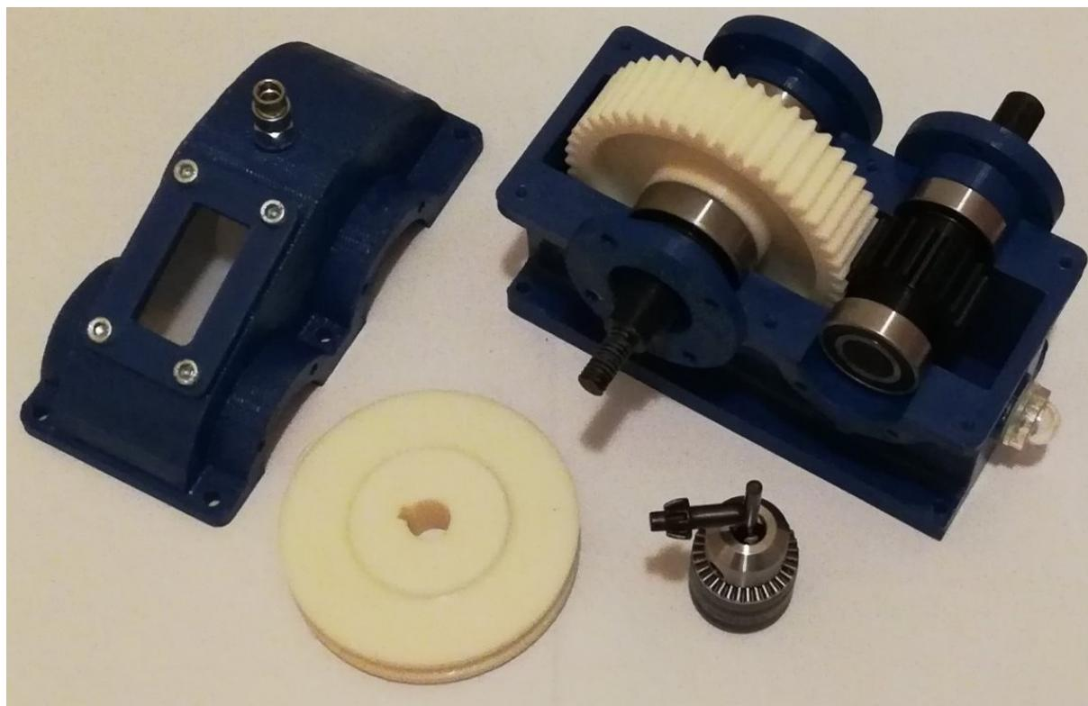
Slika 57. Spajanje dijelova reduktora prema montažnom crtežu
