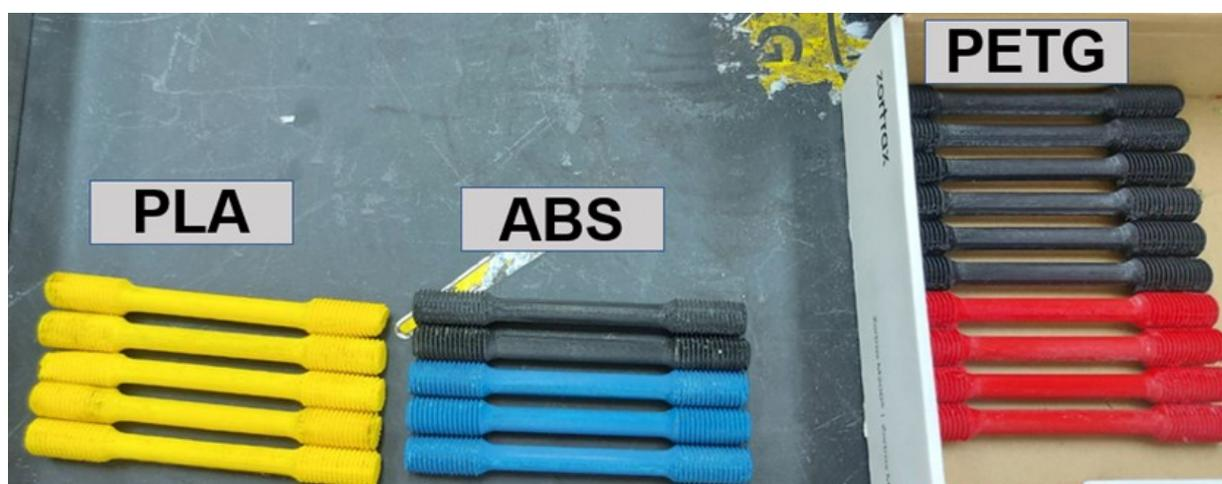
Slika 13. Ispitne epruvete za statičko vlačno ispitivanje čvrstoće od odabranih materijala
