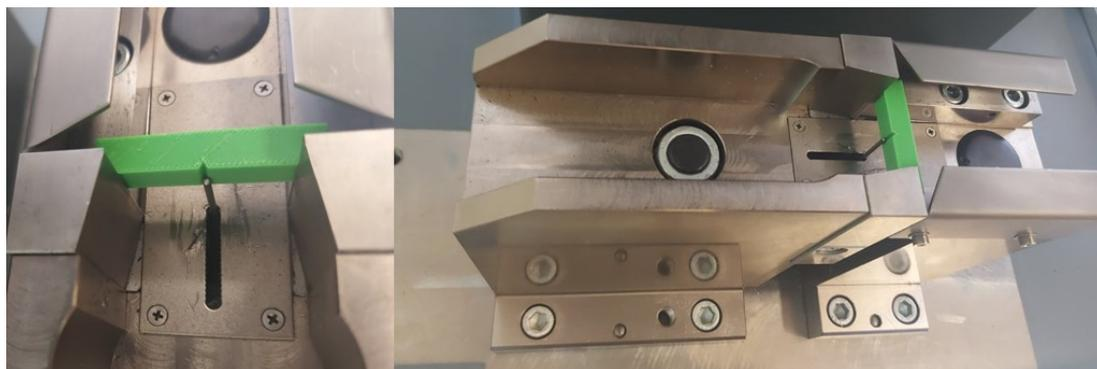
Slika 37. Postavljanje ispitnih epruveta u bat
