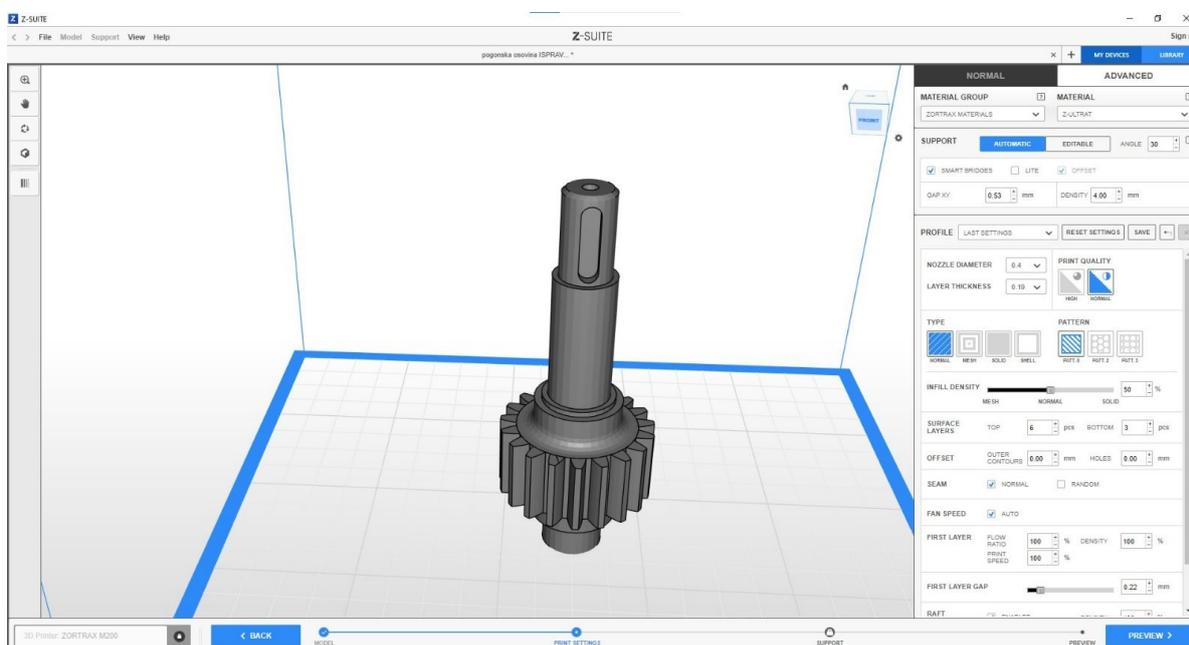
Slika 50. Podešavanje parametara za 3D tisk pogonskog zupčanika
