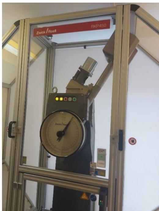
Slika 35. Charpyjev bat za ispitivanje na udar
