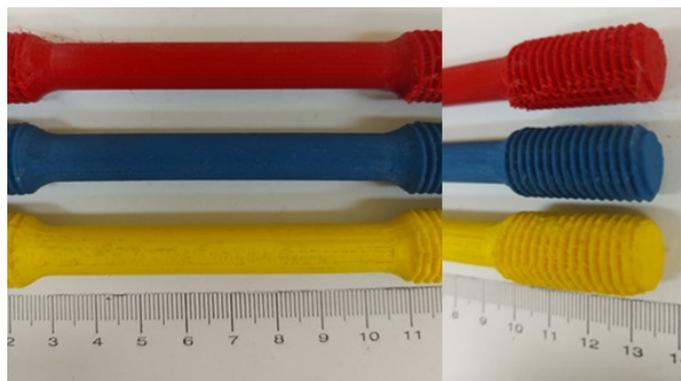
Slika 15. Prikaz ispitnih epruveta tijela i poprečnog presjeka
