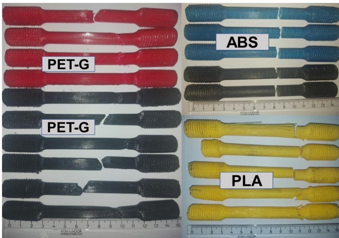
Slika 23. Sve epruvete nakon statičkog vlačnog ispitivanja čvrstoće
