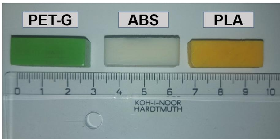
Slika 31. Ispitne epruvete za ispitivanje tvrdoće materijala
