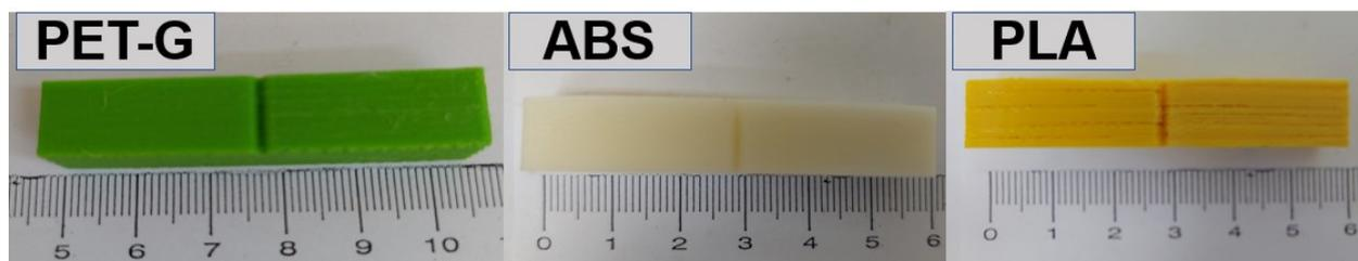
Slika 36. Uzorci epruveta za ispitivanje udarne radnje loma
