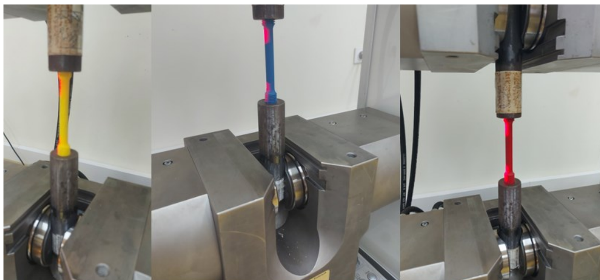
Slika 19. Postavljanje epruveta u kidalicu
