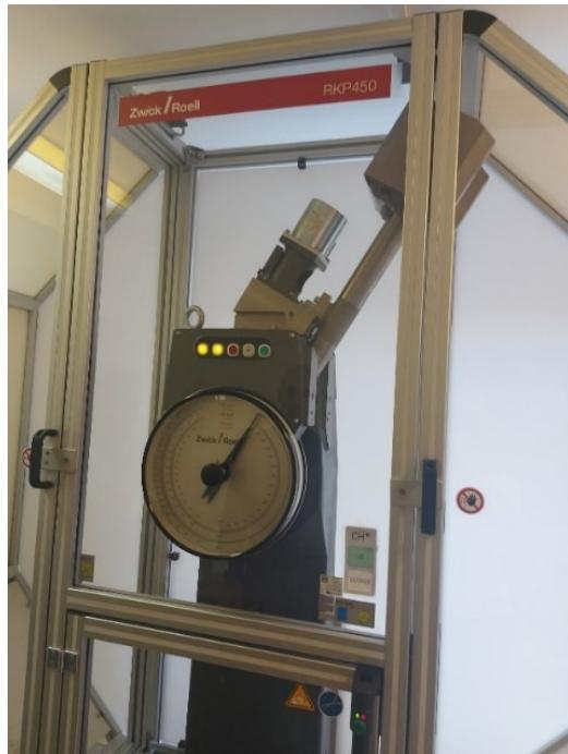
Slika 35. Charpyev bat za ispitivanje na udar
