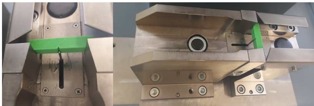
Slika 37. Postavljanje ispitnih epruveta u bat
