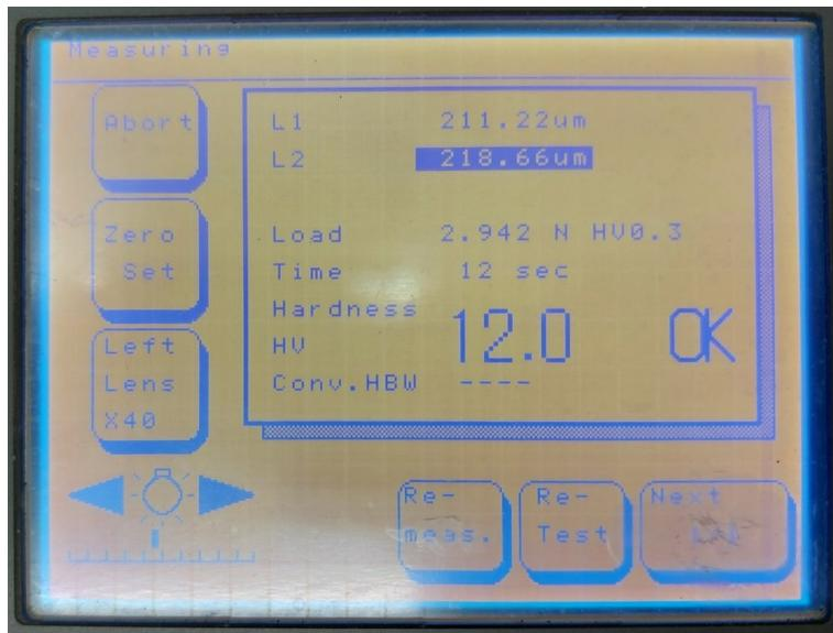
Slika 33. Prikaz rezultata ispitivanja tvrdoće ABS materijala
