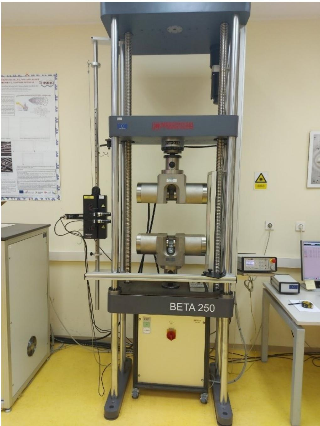
Slika 17. Hidraulička kidalica MESSPHYSIK BETA 250
