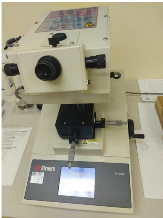
Slika 32. Uređaj za mjerjenje tvrdoće prema Vickersu STRUERS DURAMIN
