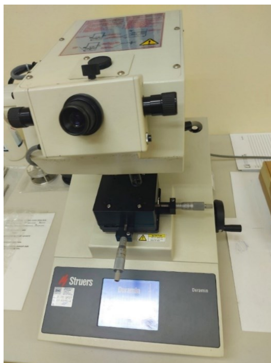
Slika 32. Uređaj za mjerenje tvrdoće prema Vickersu STRUERS DURAMIN
