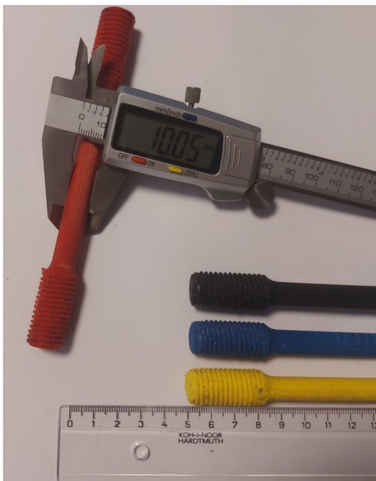
Slika 16. Mjerenje ispitnih epruveta digitalnim pomičnim mjerilom
