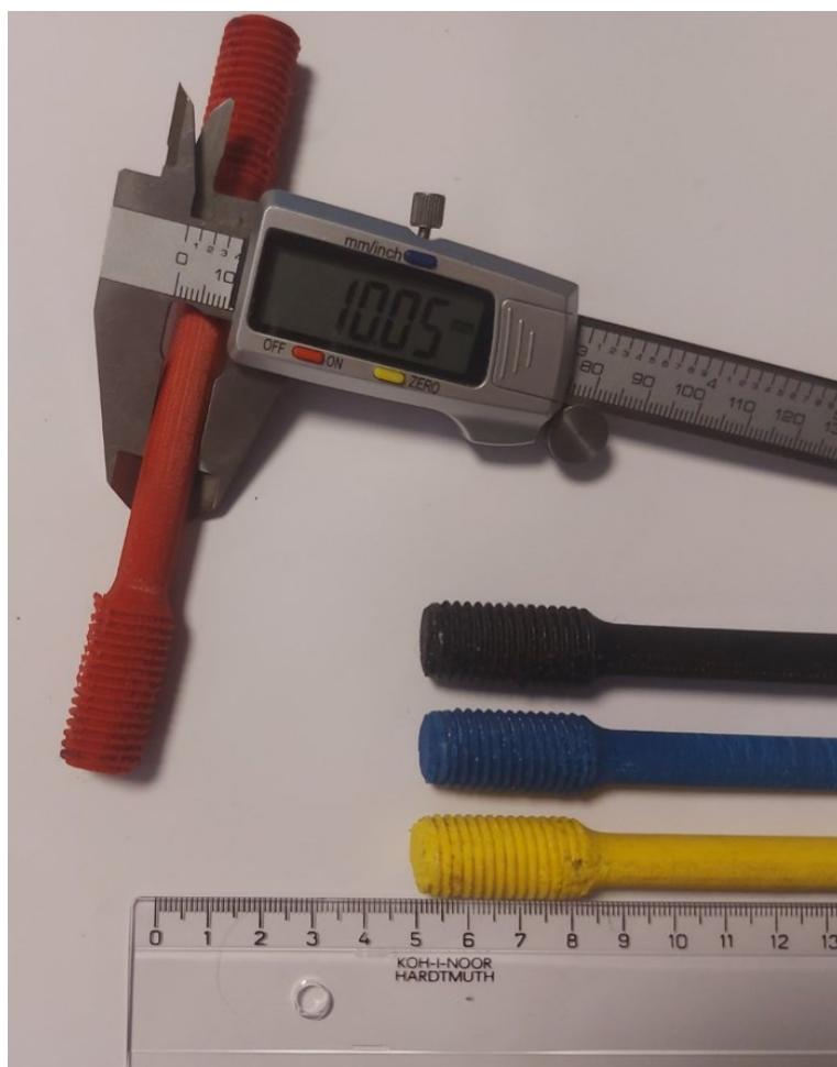
Slika 16. Mjerenje ispitnih epruveta digitalnim pomičnim mjerilom
