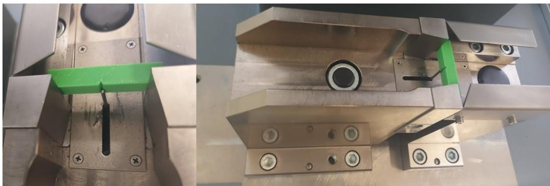
Slika 37. Postavljanje ispitnih epruveta u bat
