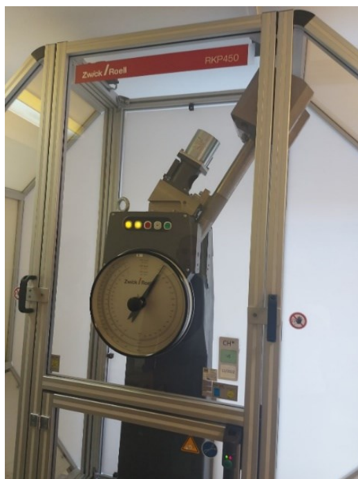
Slika 35. Charpyjev bat za ispitivanje na udar
