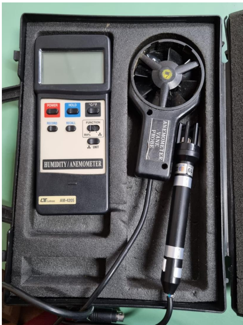
Slika 6. Mjerni instrument vlažnosti zraka – Higrometar Lutron, tip AM-4205
