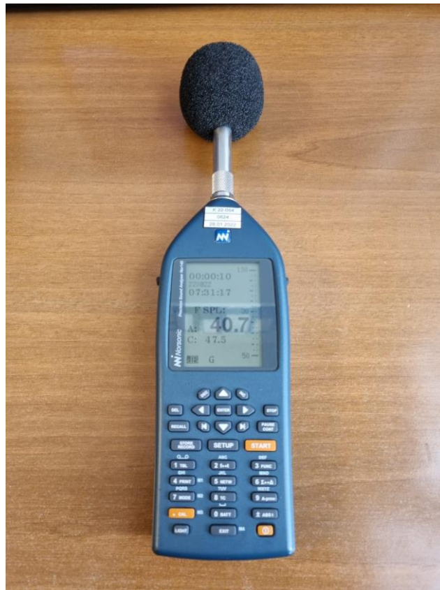
Slika 1. Zvukomjer (analizator zvuka) - Norsonic NOR 140
