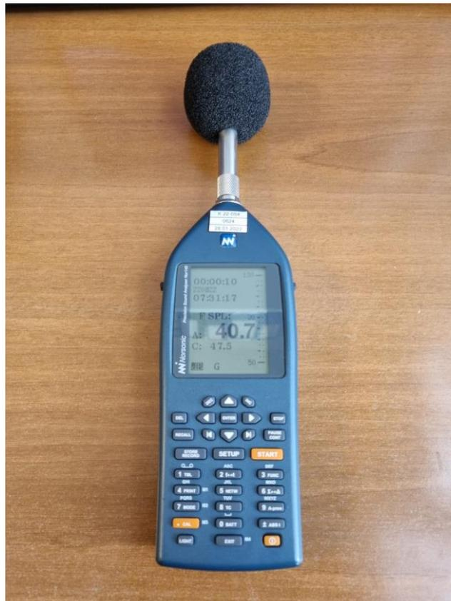
Slika 1. Zvukomjer (analizator zvuka) - Norsonic NOR 140
