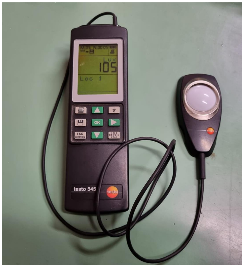
Slika 2. Mjerni instrument osvjetljenosti – Luksmetar testo 545
