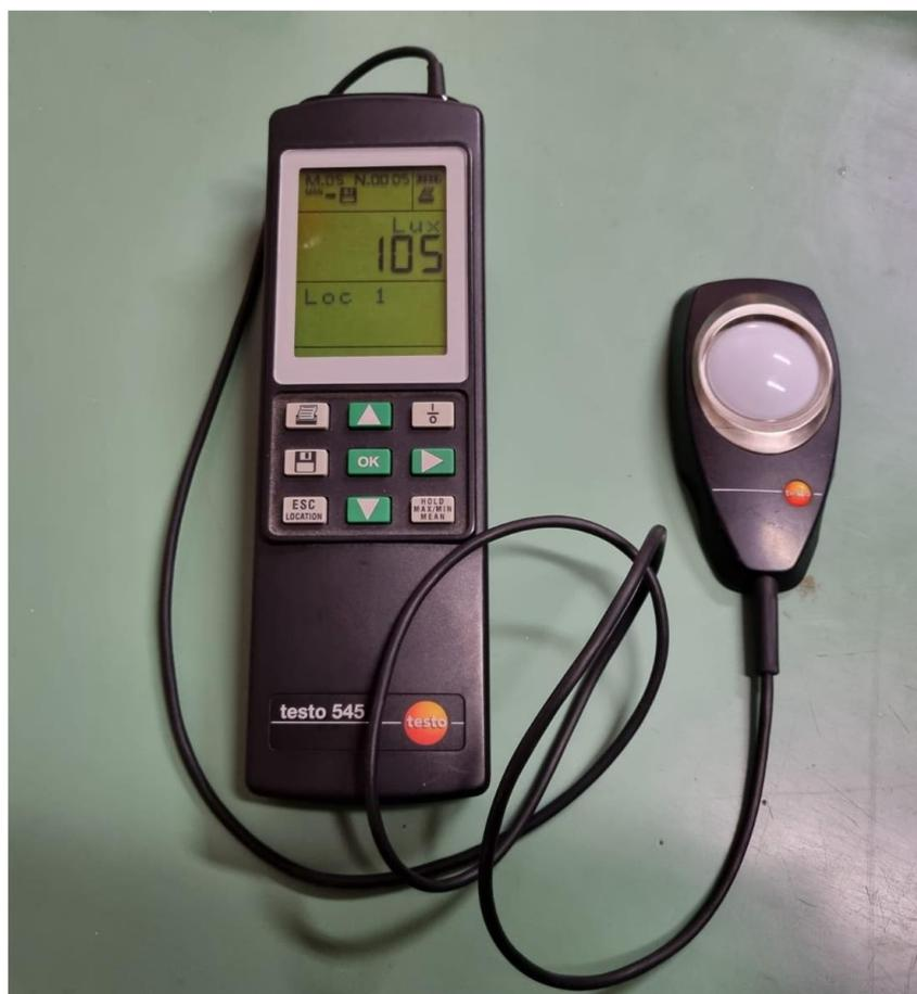
Slika 2. Mjerni instrument osvjetljenosti – Luksmetar *testo 545*
