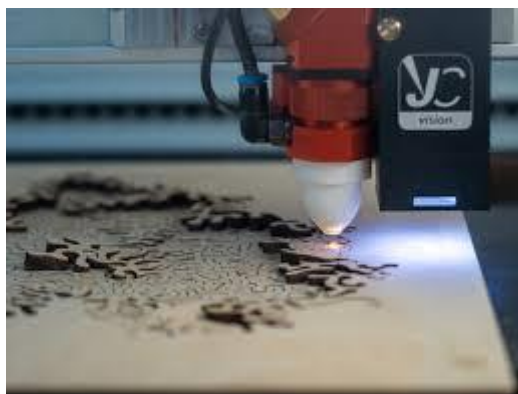
Slika 12. Mlaznica laserskog stroja
