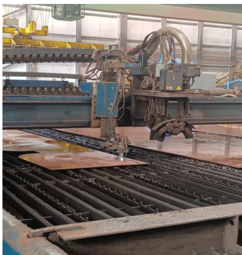
Slika 16. Plazma stroj ESAB TXB 10200
