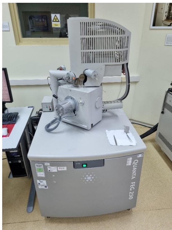
Slika 42: FEI Quanta 250 FEG SEM instrument
