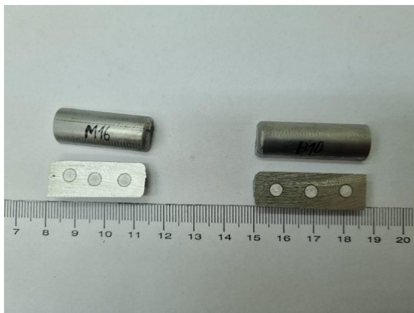
Slika 39: Prikaz uzorka nakon testiranja GDS uređajem
