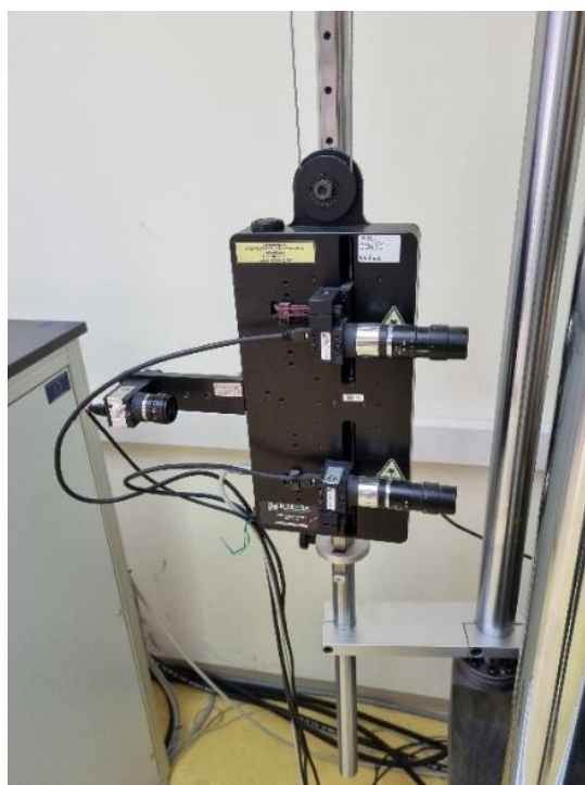
Slika 23: Laserski ekstenzometar ME 53 – 250 i digitalna kamera
