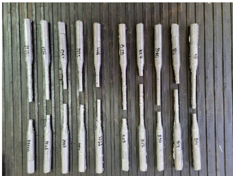
Slika 25: Testne epruvete nanokompozita nakon vlačnog testa
