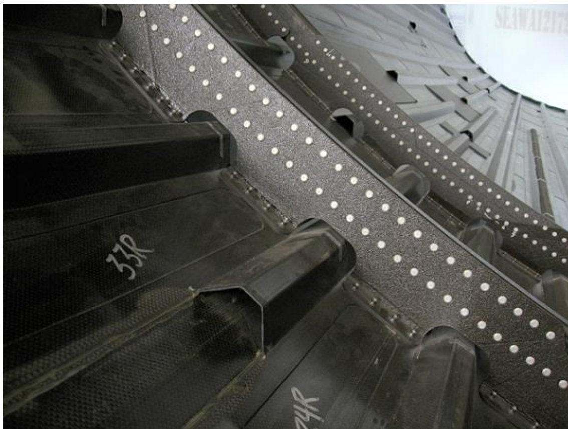
Slika 5: Boeing 787 trup, napravljen od plastičnog kompozita
