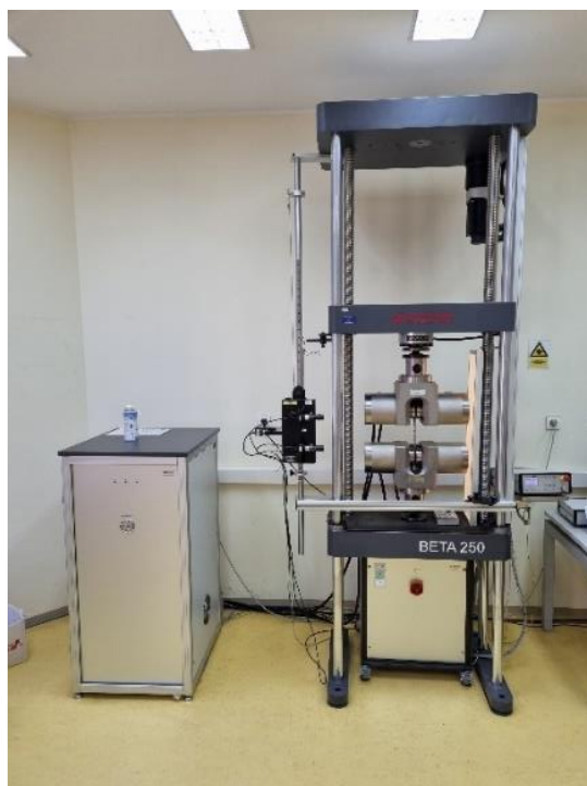
Slika 22: Univerzalna statička kidalica Messphysik BETA250
