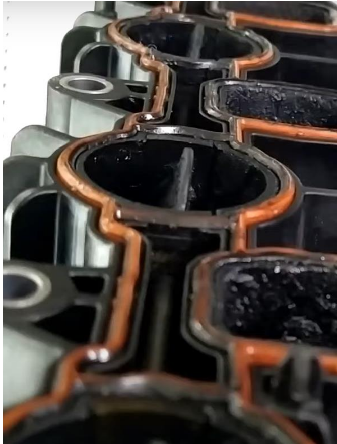
Slika 43: Prikaz pravilnog položaja potpuno otvorenih zaklopki
