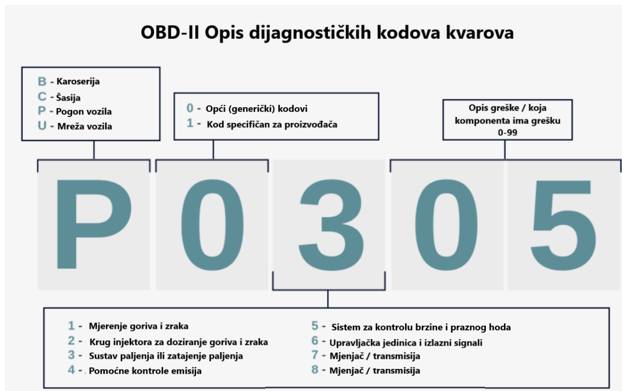
Slika 9: Značenje kodova kvarova
