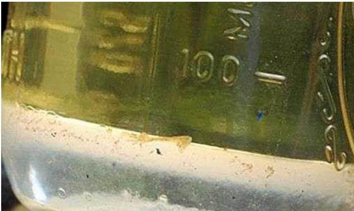
Slika 21: Nakupljena voda na dnu rezervoara goriva
