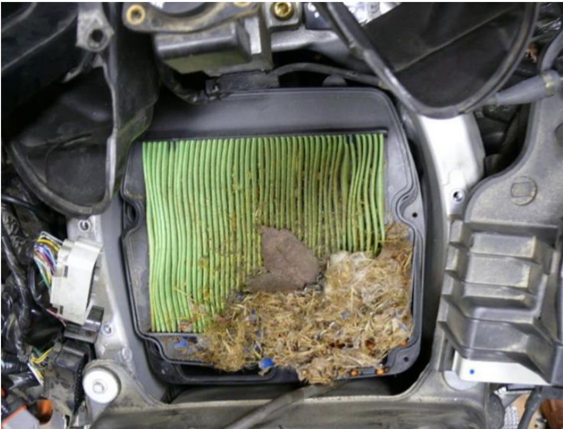
Slika 17: Začepljeni filter zraka iz vozila koje je imalo problema sa nedostatkom snage, nečistoće blokiraju velik dio protoka zraka u motor
