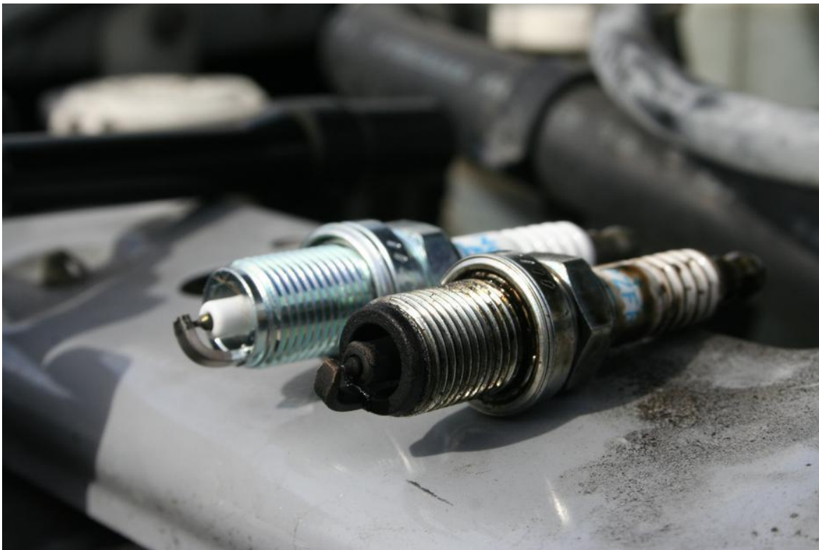
Slika 24: Usporedba neispravne stare i nove svjećica
