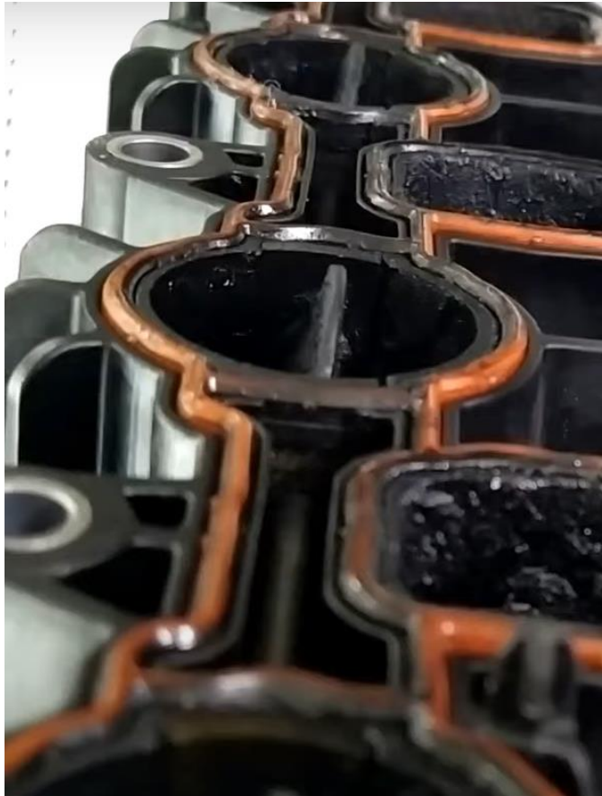
Slika 43: Prikaz pravilnog položaja potpuno otvorenih zaklopki
