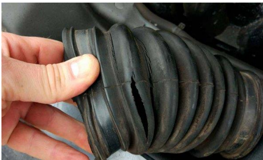
Slika 19: Prikaz puknuća vakuumske cijevi
