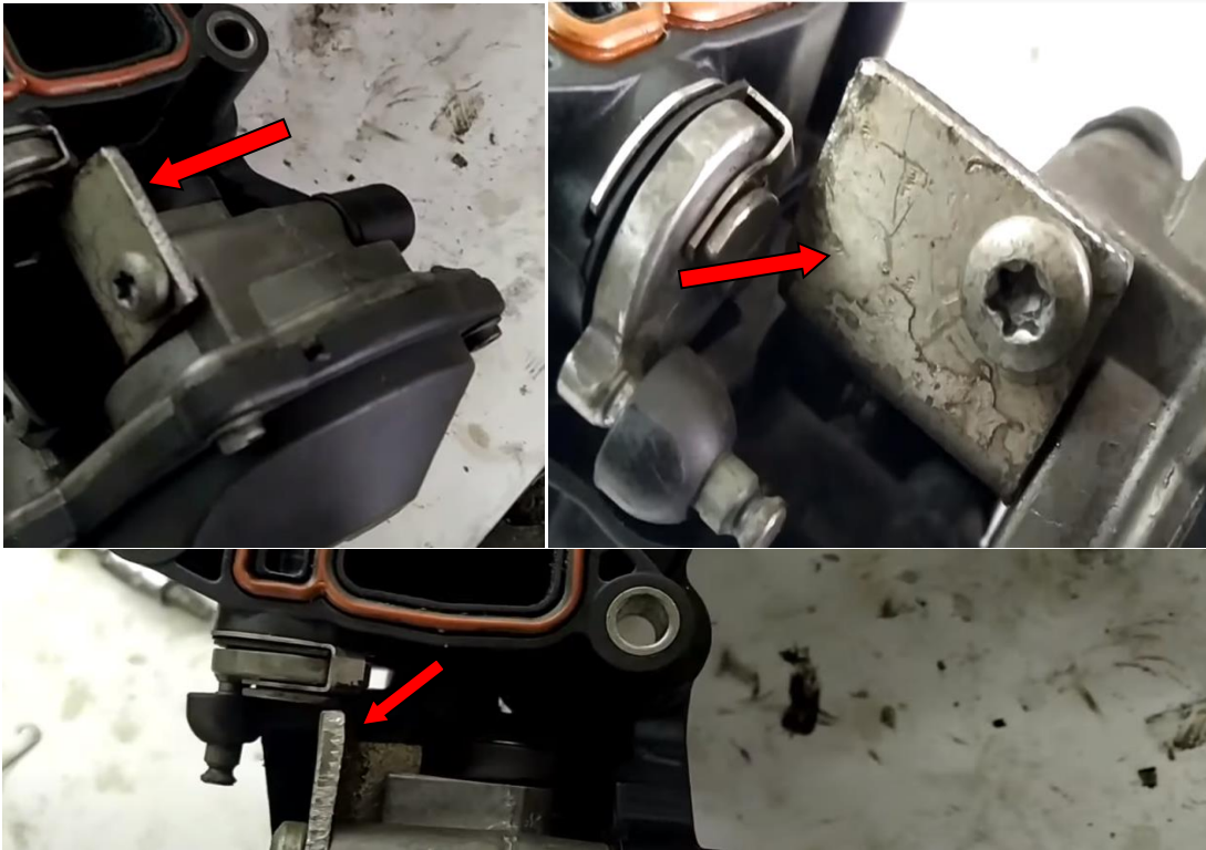
Slika 46: Napravljeni graničnik položaja
