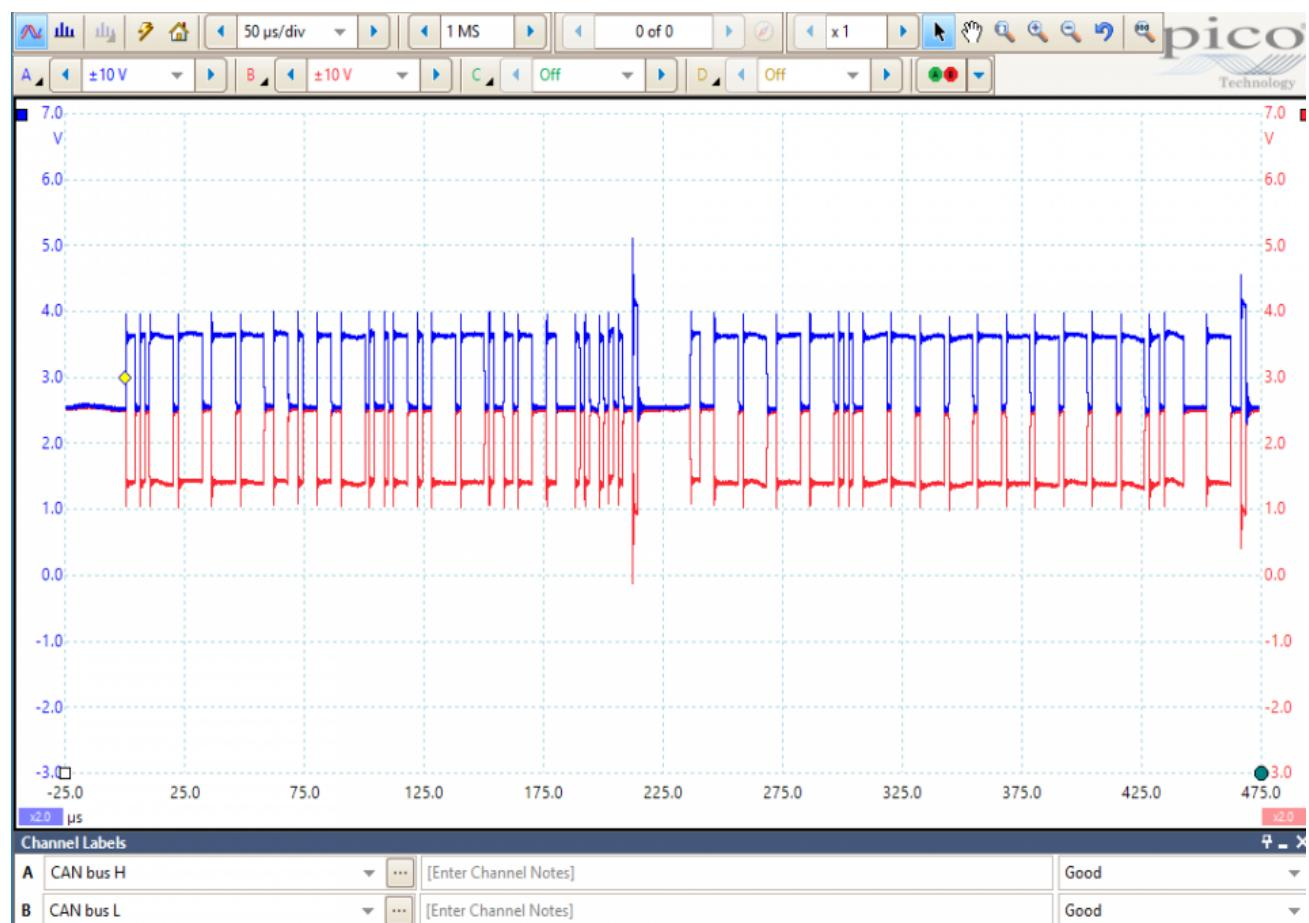
Slika 15: Primjer valnog oblika signala unutar "okvira"
