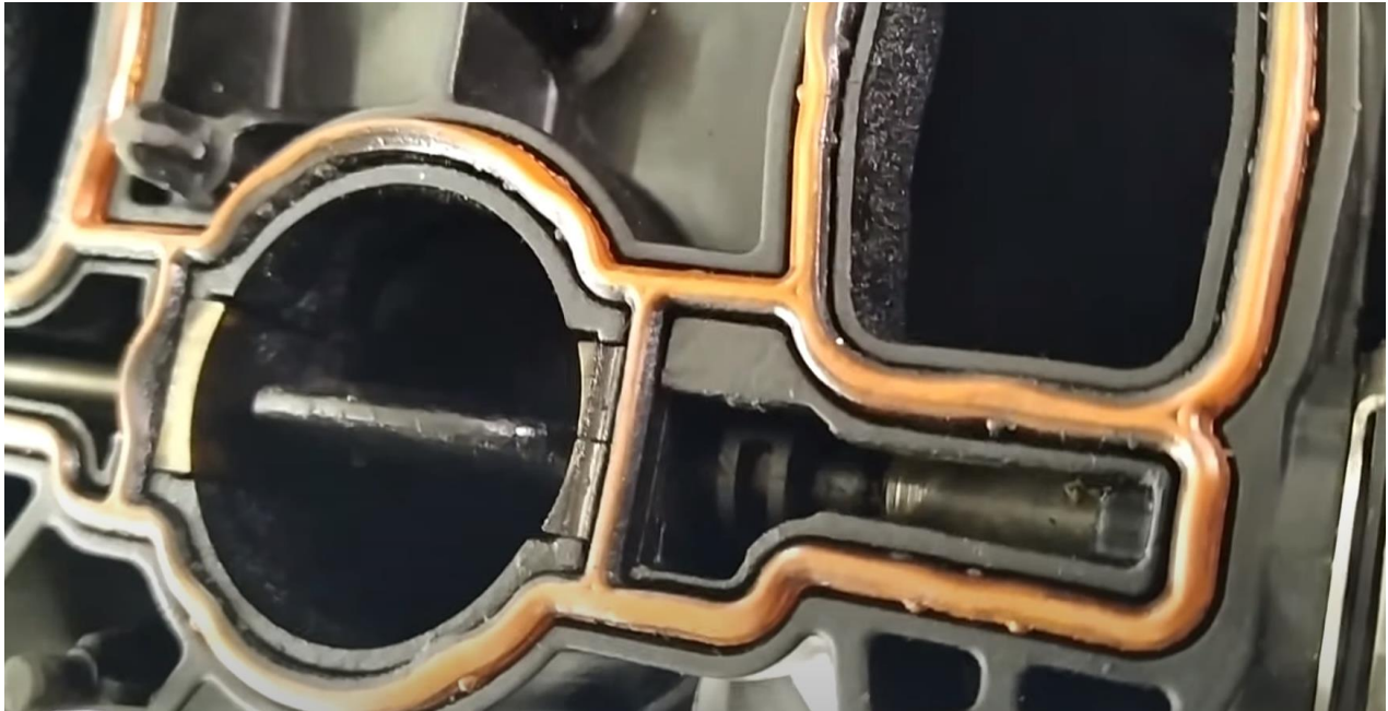
Slika 48: Prikaz ispravnog položaja zaklopki (kut od 90°)
