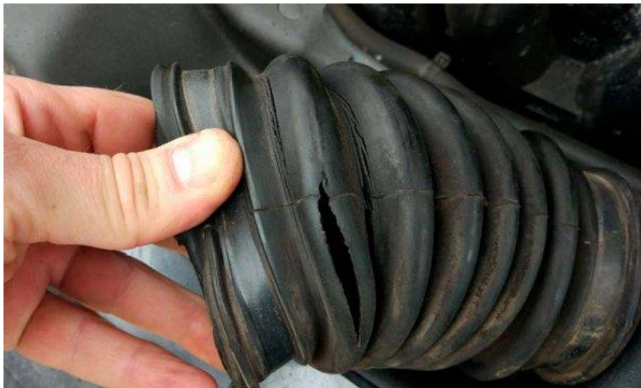
Slika 19: Prikaz puknuća vakuumske cijevi
