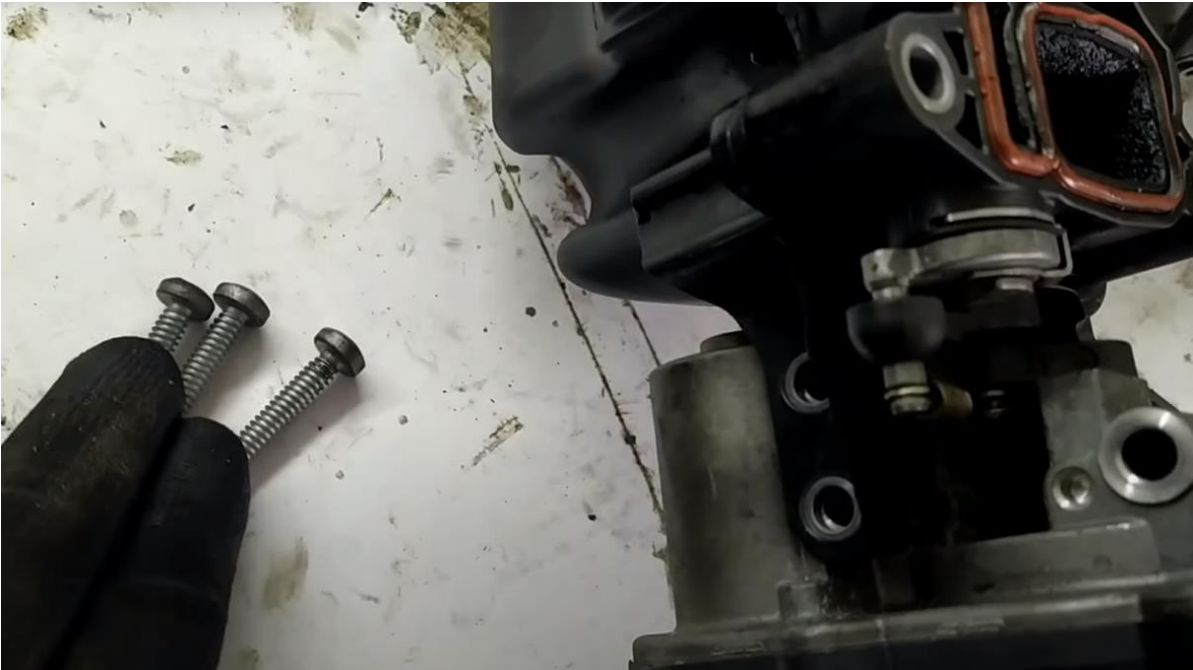
Slika 44: Početak odvajanja elektromotora od usisne grane – skidanje vijaka
