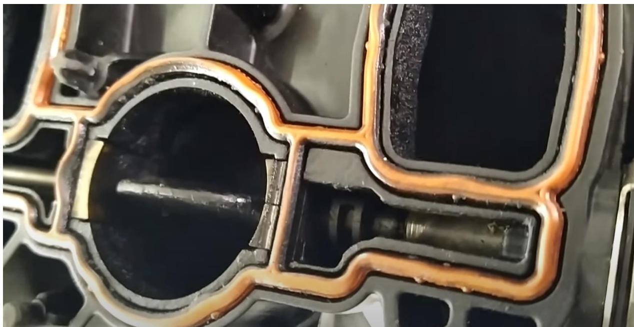
Slika 48: Prikaz ispravnog položaja zaklopki (kut od  $90^\circ$ )
