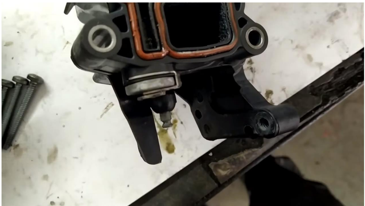
Slika 45: Mjesto pričvršćenja elektromotora sa usisnom granom
