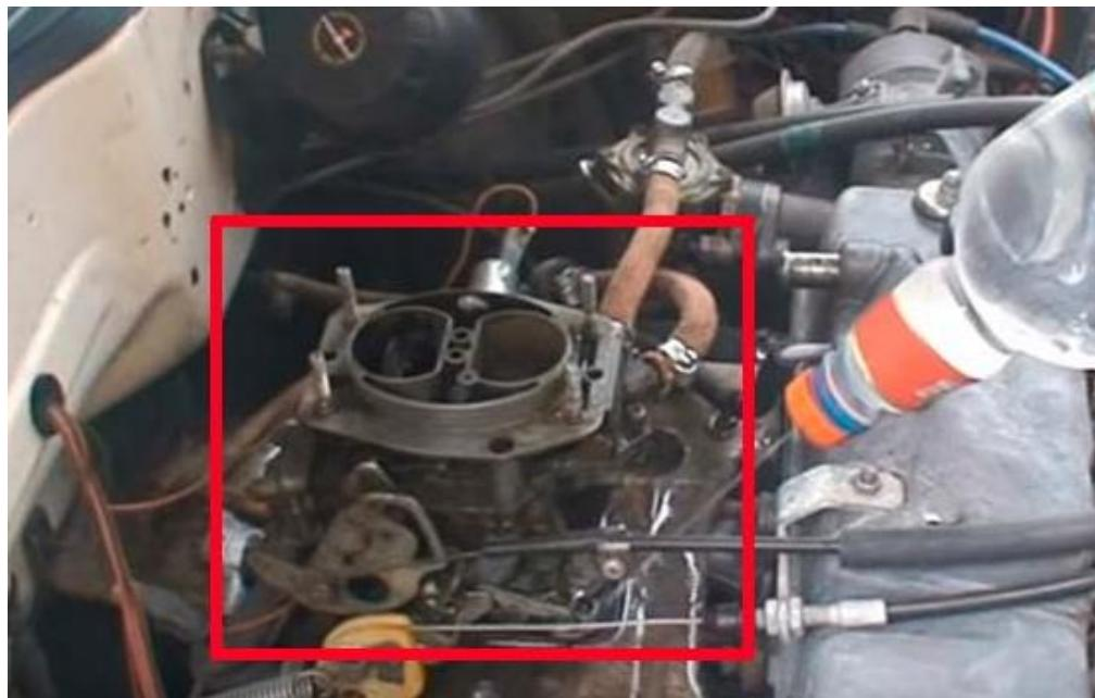
Slika 20: Metoda dijagnostike propusnosti zraka pomoću vode
