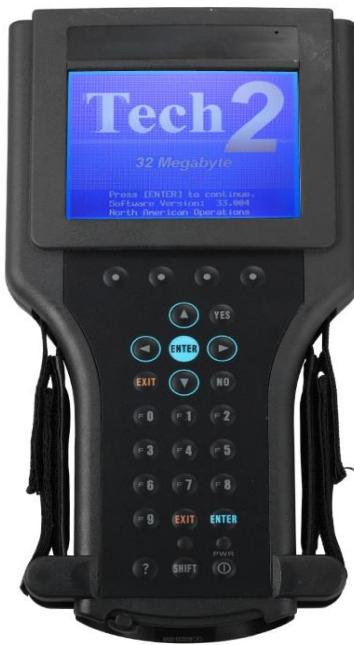
Slika 25: Alat za skeniranje „General Motorsa - Tech 2“
