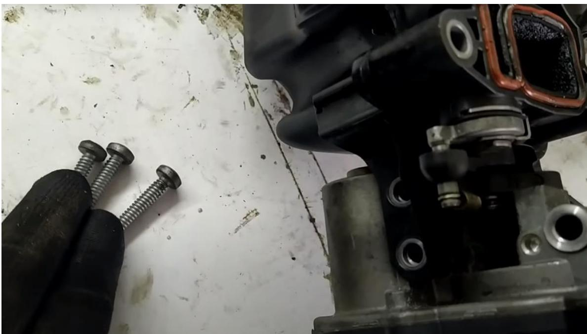
Slika 44: Početak odvajanja elektromotora od usisne grane – skidanje vijaka
