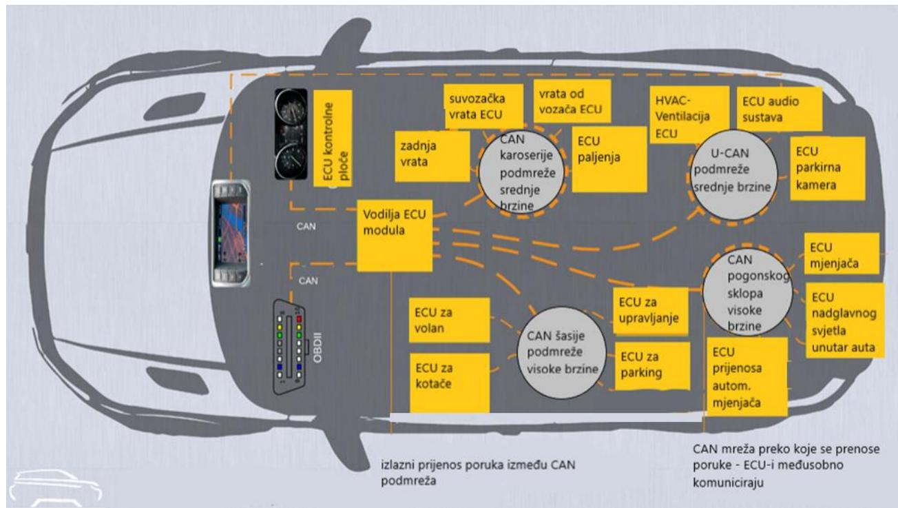
Slika 10: Sabirnica mreže kontrolera CAN u inteligentnom vozilu, gdje se informacije iz upravljačkih električnih jedinica prikupljaju na CAN sabirnici preko CAN čvorova
