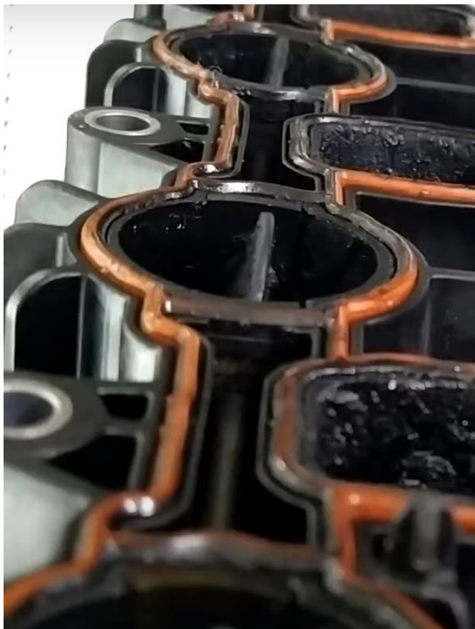
Slika 43: Prikaz pravilnog položaja potpuno otvorenih zaklopki
