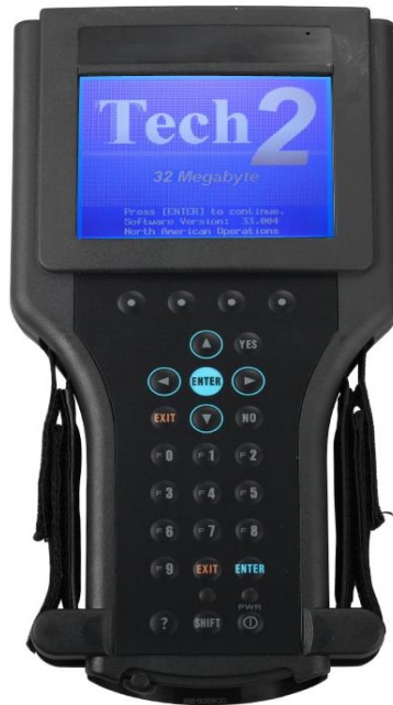
Slika 25: Alat za skeniranje „General Motorsa - Tech 2“
