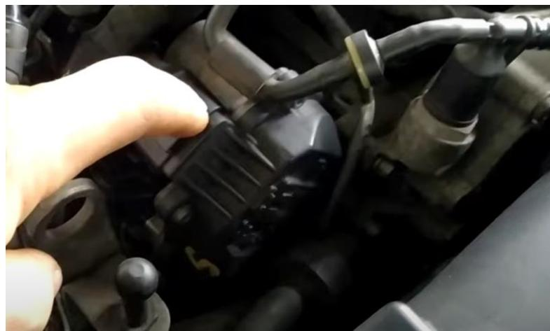
Slika 37: Elektromotor unutar kojeg se nalazi senzor položaja
