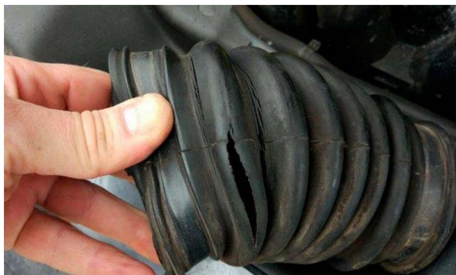
Slika 19: Prikaz puknuća vakuumске cijevi
