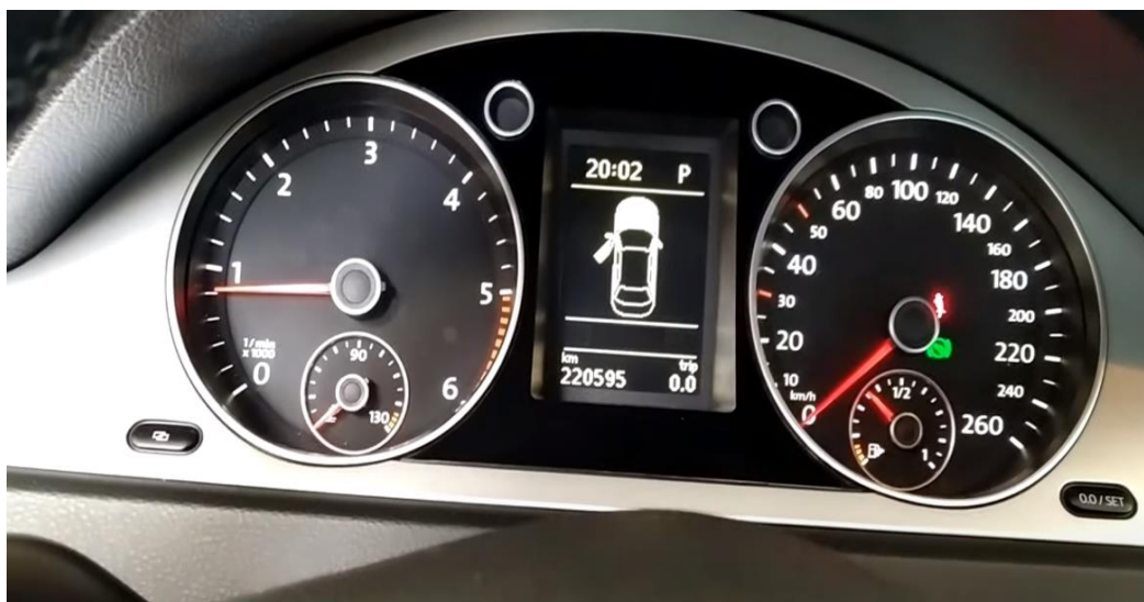
Slika 51: Kontrolna tabla u automobilu nakon popravka - bez grešaka
