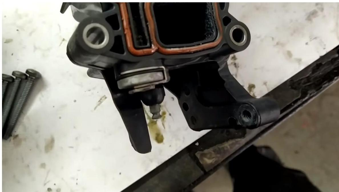
Slika 45: Mjesto pričvršćenja elektromotora sa usisnom granom
