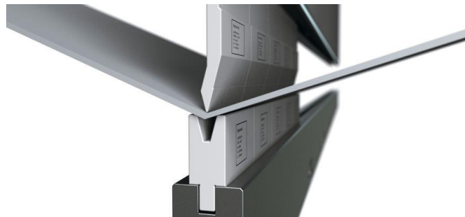
Slika 15 Zračno savijanje lima; izvor: https://www.laser-ing.hr/wp-content/uploads/2022/07/savijanje-lima.jpg
