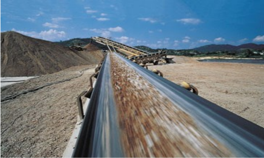
Slika 3. Trakasti transporter u radu
