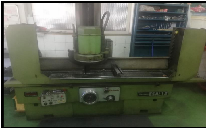
Slika 29.: Stroj za obradu baze bloka motora
