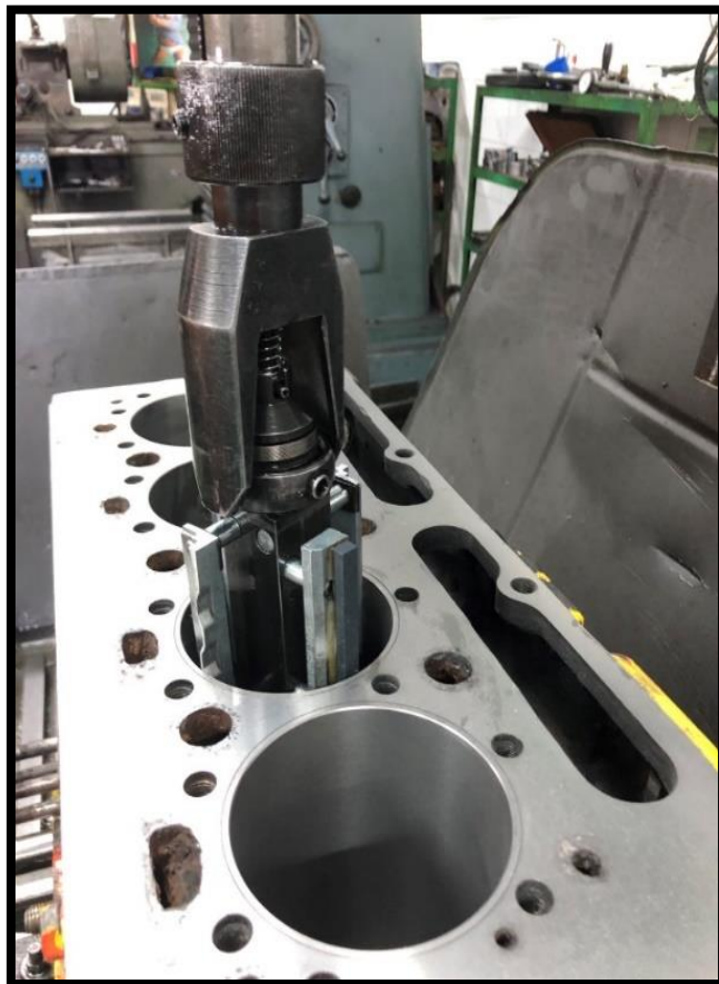
Slika 37.: Kamen za obradu honanjem
