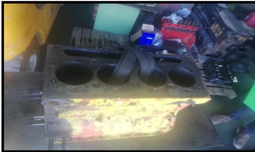
Slika 19.: Skinuti blok motora
