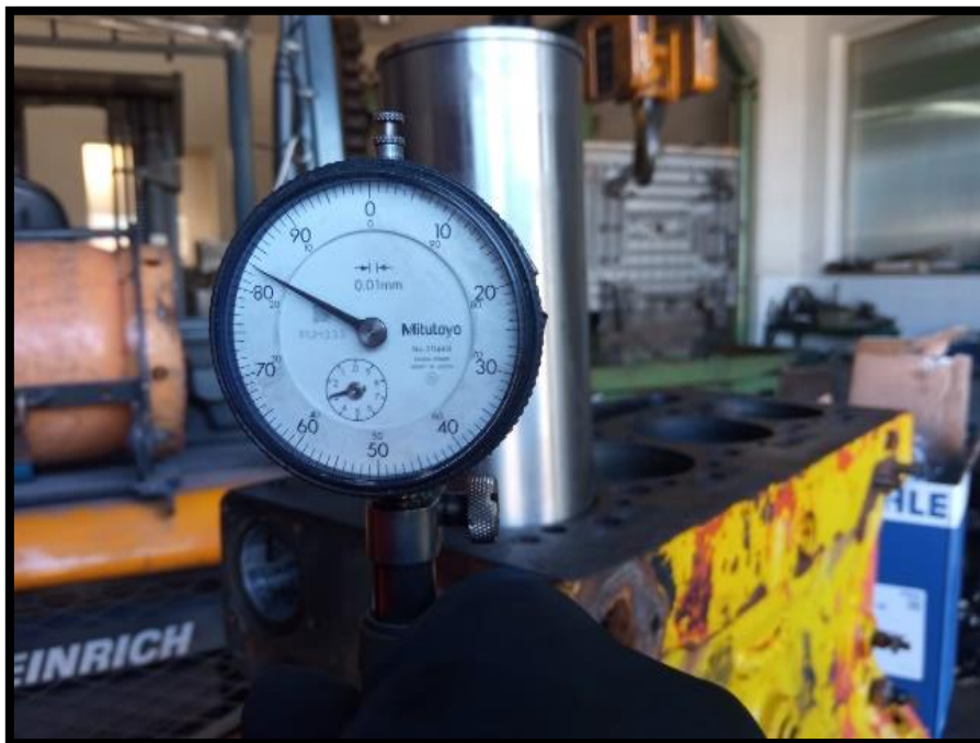
Slika 21: Izmjereno prvo odstupanje istrošenosti na košuljici cilindra 0,17 mm
