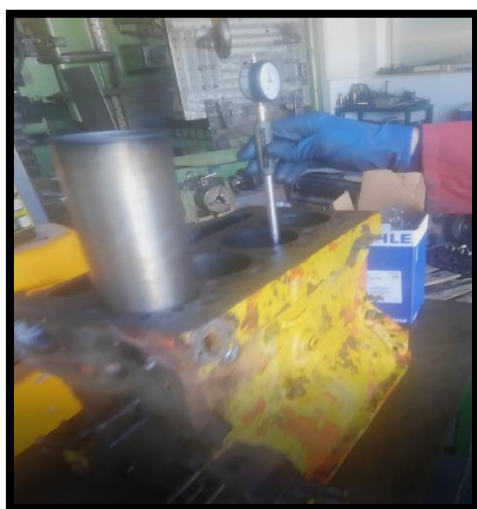
Slika 27.: Mjerenje preklopa košuljice i provrta bloka motora
