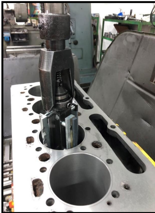
Slika 37.: Kamen za obradu honanjem
