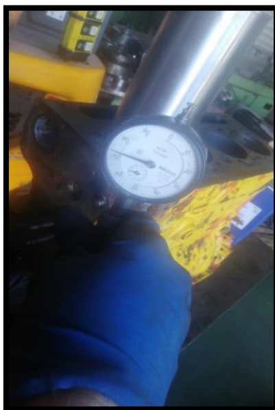
Slika 22.: Izmjereno drugo odstupanje istrošenosti na košuljici cilindra 0,28 mm
