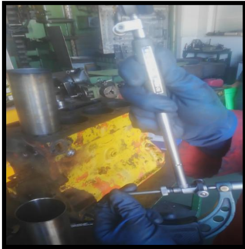
Slika 26.: Prenošenje mjere vanjskog promjera košuljice sa mjernog mikrometra na štapnu mjernu uru
