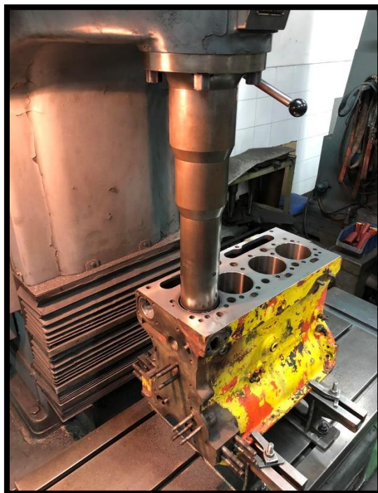
Slika 32.: Ulaz glave tokarilice u košuljicu cilindra
