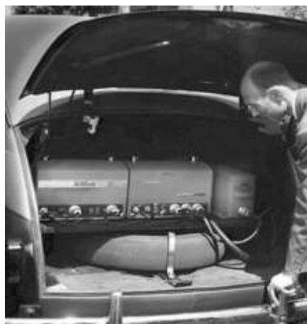
Slika 4. Transreciever (primopredajnik) telefona
