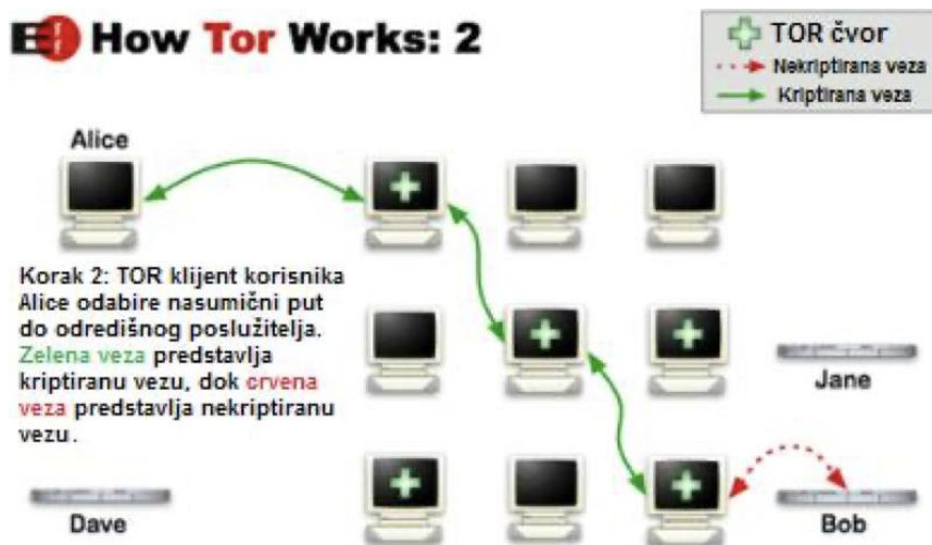
Slika 18. Način rada TOR-a, 2. korak (cis.hr, 2012.).
