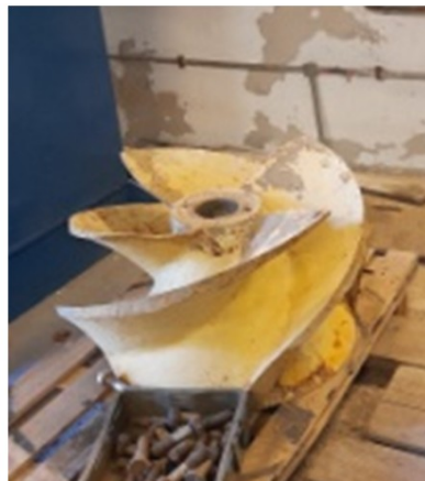
Slika 46. Rotor pumpe morske vode TE Plomin 2 [autor]
