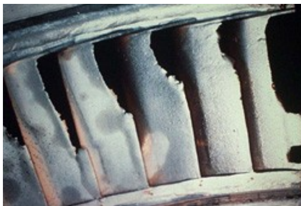
Slika 21. Erozija lopatica na zadnjem stupnju turbine [5]
