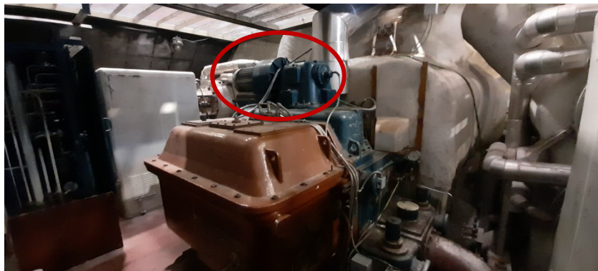
Slika 36. Prekretni stroj turbine [autor]
