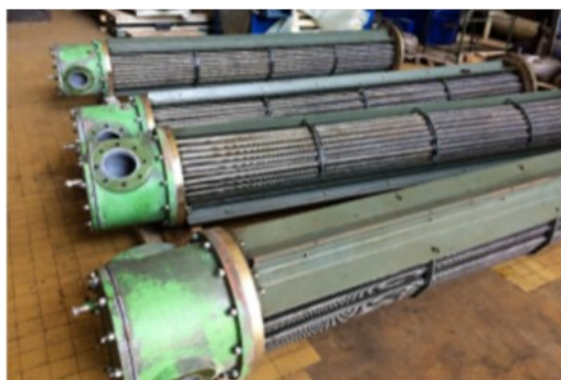
Slika 49. Hladnjaci za vodik - radni medij morska voda [12]
