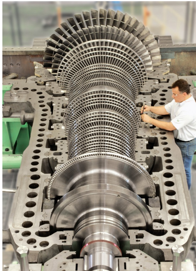
Slika 11. Otvoreno kućište parne turbine [4]
