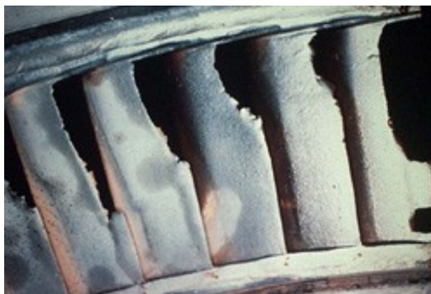
Slika 21. Erozija lopatica na zadnjem stupnju turbine [5]
