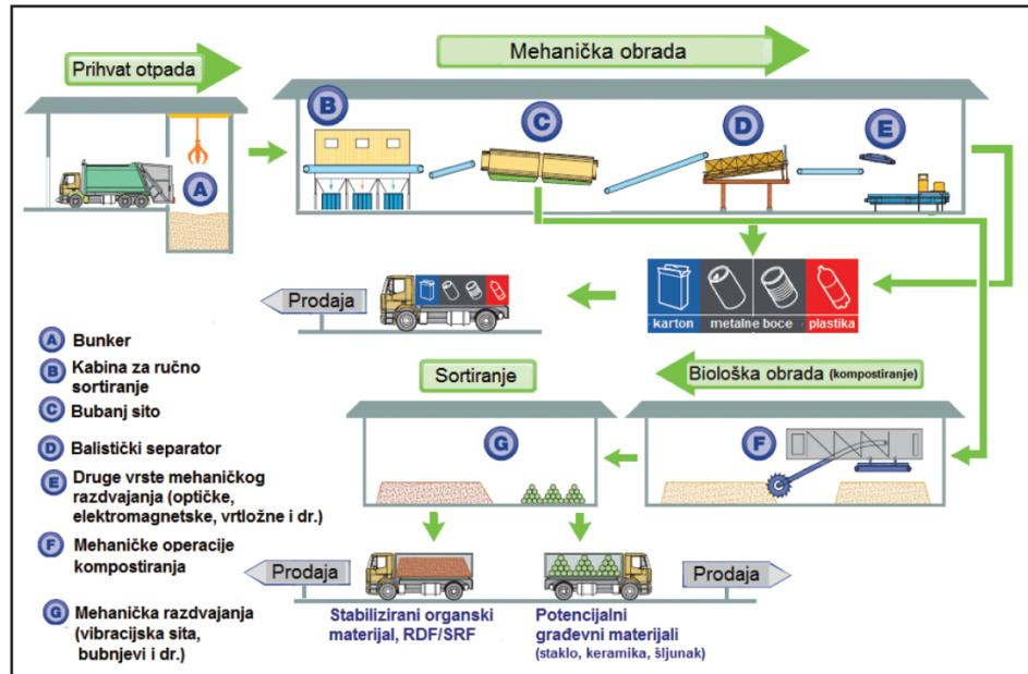
Slika 4. Shema postrojenja za mehaničko-biološku obradu [47].
