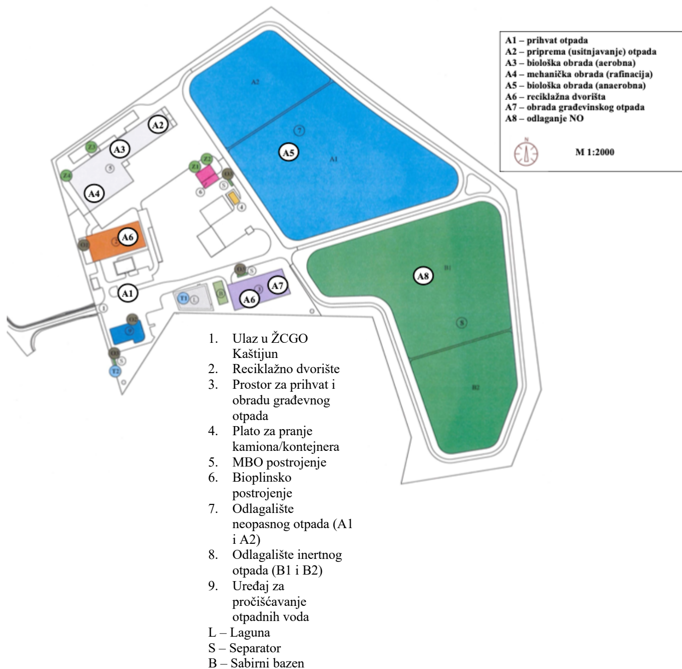
Slika 12. Nacrt prostornog plana i razmještaja tehnoloških procesa unutar ŽCGO-a Kaštijun [58].
