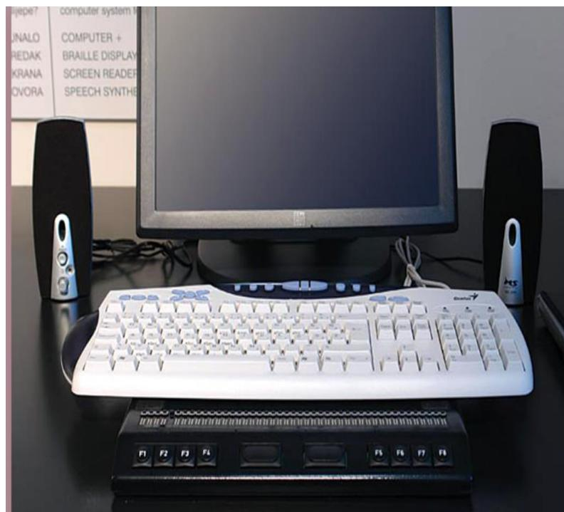
Slika 4. Braillev redak kod stolnog računala (izvor: <https://www.tifloloskimuzej.hr/hr/stalni-postav/ukorak-s-vremenom/predmet-brailleov-redak>)
