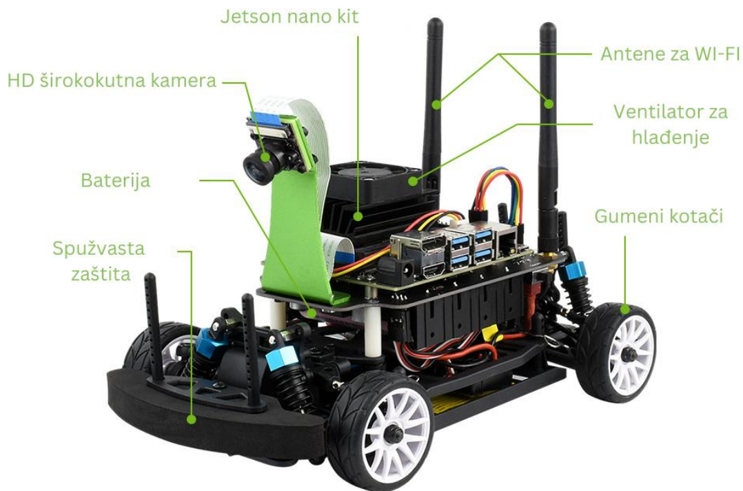
Slika 9. – Prikaz komponenti Nvidia Jetson Nano robota (Nvidia Jetson Nano Developer Kit)
