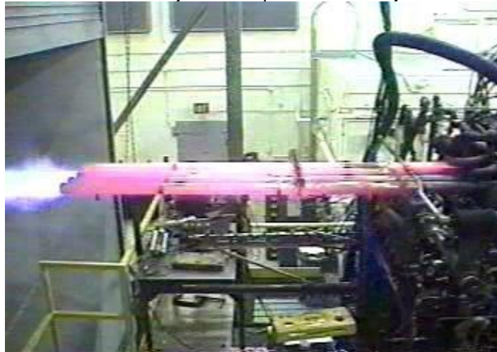
Slika 3. Pulsni detonacijski motor prilikom testiranja u laboratoriju.
