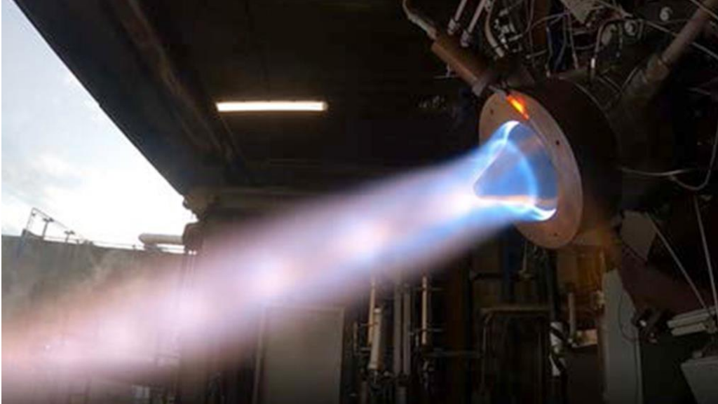
Slika 4. Rotacijski detonacijski motor prilikom testiranja u laboratoriju Američkog ratnog zrakoplovstva.
