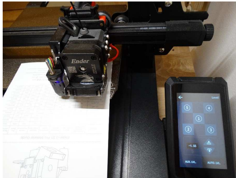
Slika 5.16 Postupak niveliranja podloge 3D pisača
