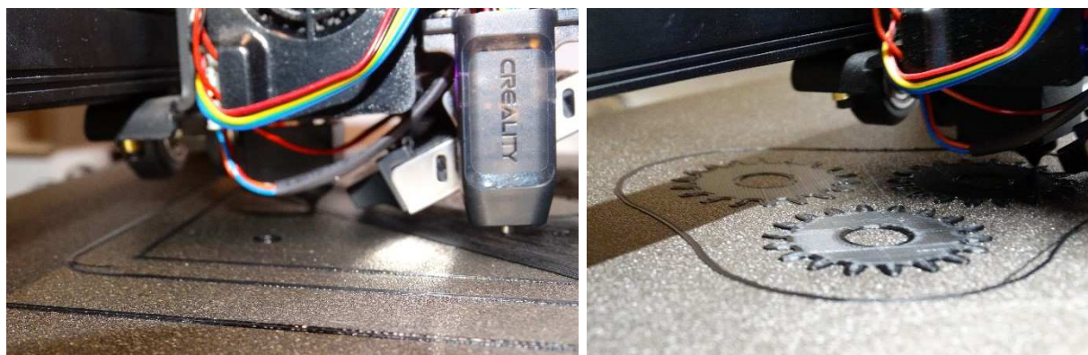
Slika 5.17 Prikaz početka postupka ispisa stražnjeg poklopca i planetarnih zupčanika
