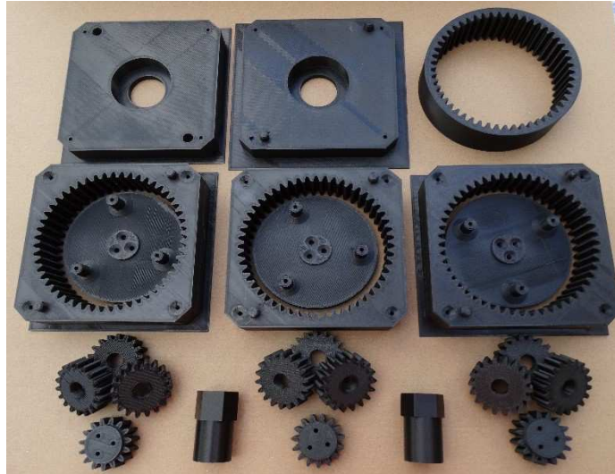
Slika 5.19 Prikaz svih komponenti 3D ispisa za sklop planetarnog multiplikatora
