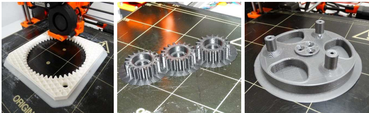
Slika 5.32 Postupak ispisa nekih komponenti
