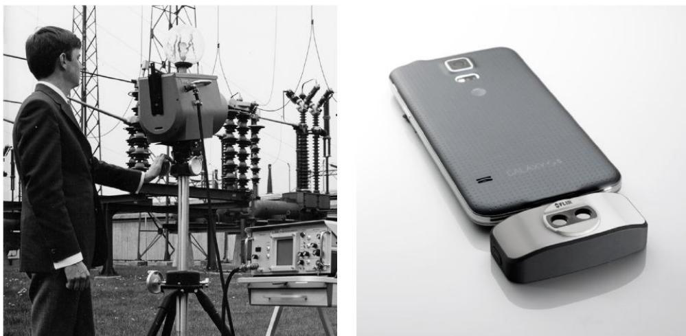
1969. Termografska kamera, Model 661, Težina: kamere 25 kg, osciloskopa 20 kg, stativ 15 kg. Operateru je također bio potreban generator za izmjeničnu struju (AC) od 220 V i staklenka od 10 L tekućeg dušika za hlađenje kamere.
