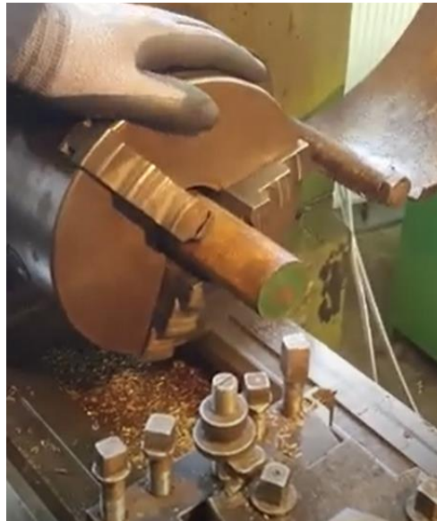
Slika 31. Obradak umetnut u steznu glavu
