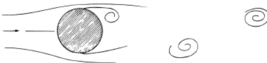
Slika 5.4: Pojava vrtloženja uslijed morskih struja [7]
