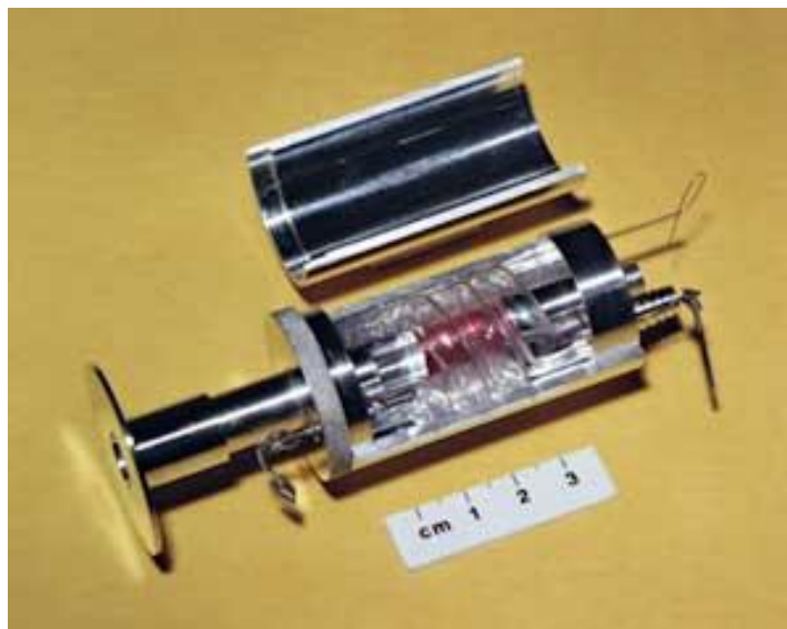
Slika 2 Prvi rubinski laser
