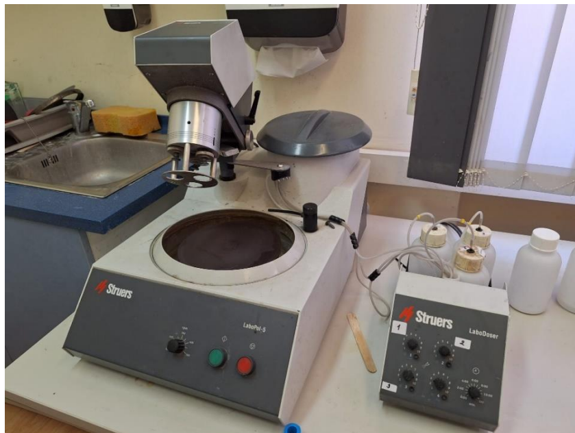
Slika 9: Uređaj STUERS LABOPOL
