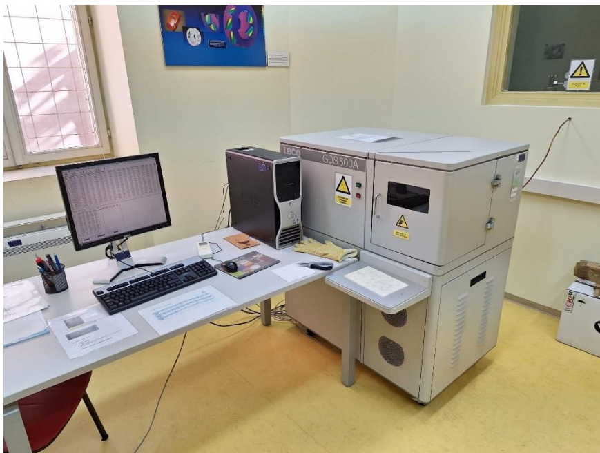
Slika 7: Optički emisijski spektrometar GDS500A LECO
