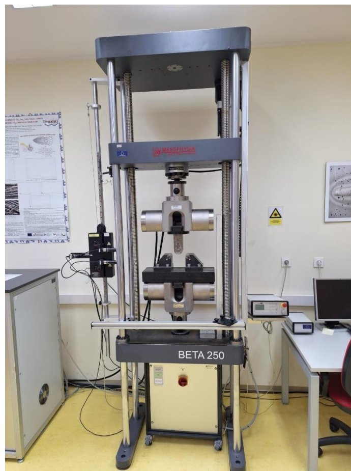
Slika 14: Univerzalnoj statička kideralica BETA250, tvrtke Messphysik
